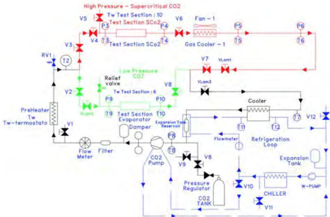
**Figura 2.1 Schema del circuito idraulico dell’impianto CO<sub>2</sub>ATTO**
