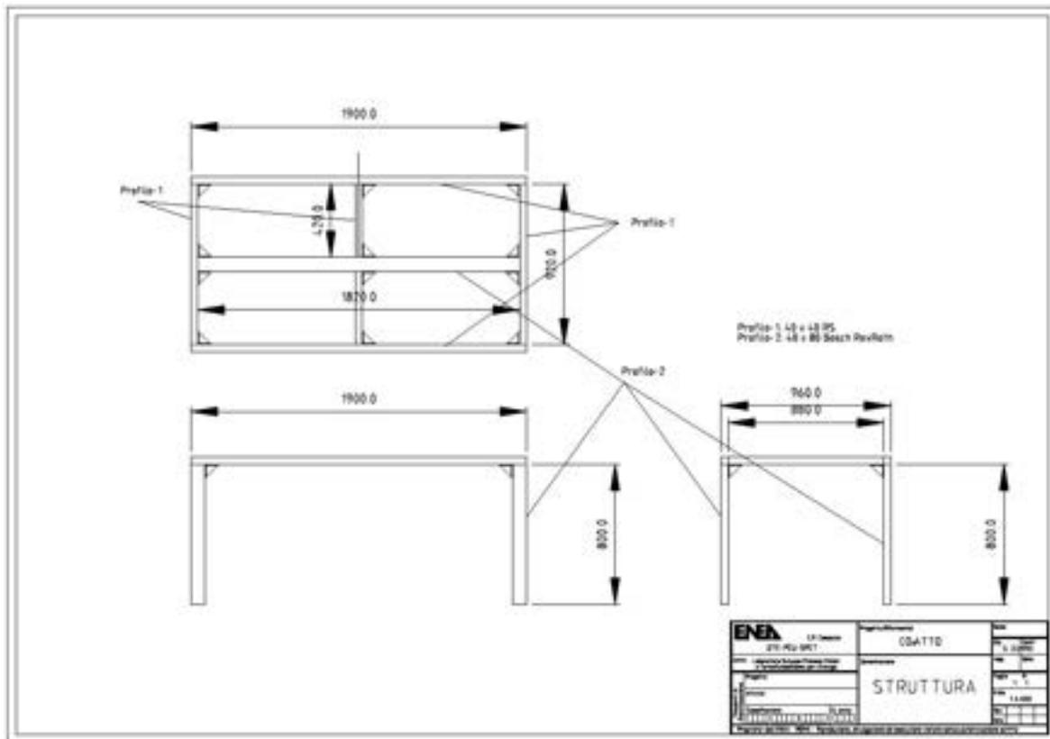
Figura 2.2 Disegno del rack dell'impianto CO<sub>2</sub>ATTO
