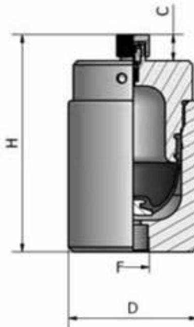
Figura 2.6. Schema dello smorzatore di pulsazioni (Damper)
