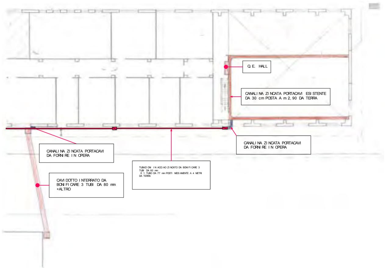
Figura 2.16 – Schema del percorso dei cavi elettrici
