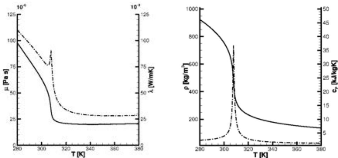
**Figura 1.1. Proprietà termofisiche della CO<sub>2</sub>. Sinistra: andamento della viscosità cinematica  $\mu$  (linea continua) e della conducibilità termica  $\lambda$  (linea tratto e punto). Destra: andamento della densità  $\rho$  (linea continua) e del calore specifico a pressione costante  $c_p$  (linea tratto e punto)**
