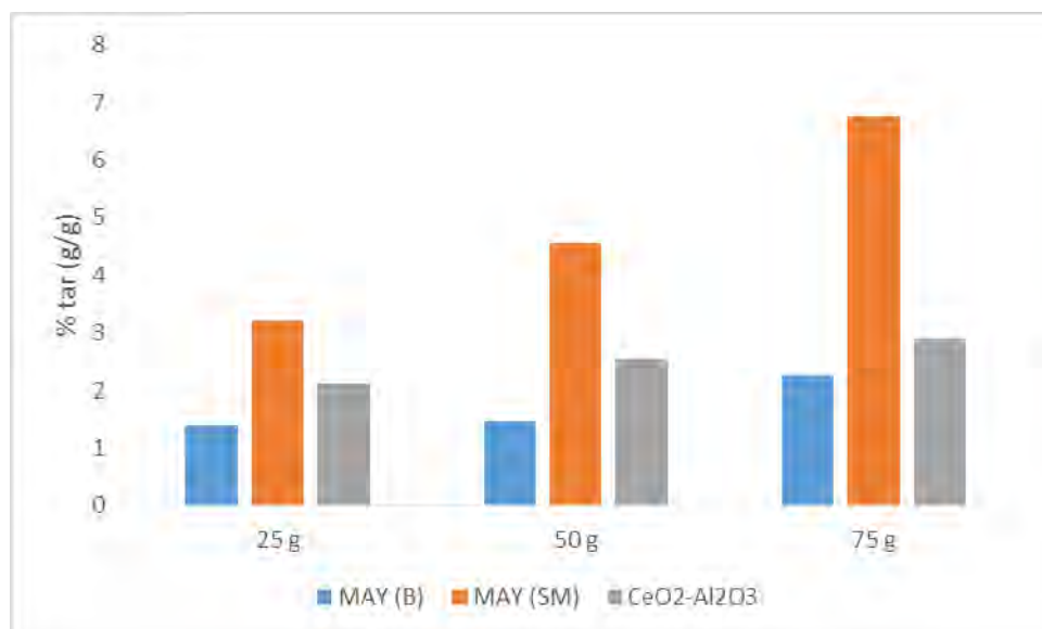
Figura 15: Quantità di tar in uscita dal letto fisso per i tre materiali in funzione dei grammi di biomassa alimentata.
