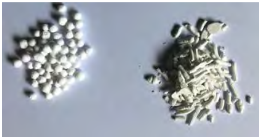
Figura 7: da sinistra verso destra mayenite depositata su sfere di allumina, mayenite estrusa in cilindretti e \text{CeO}_2 su allumina.
