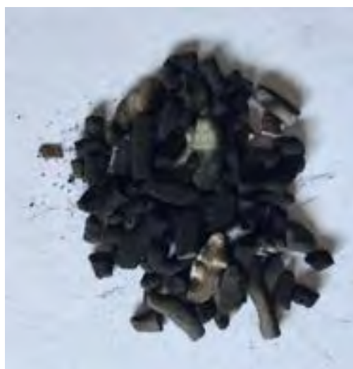
Figura 16: Mayenite estrusa dopo l'utilizzo nel reattore di abbattimento del tar.
