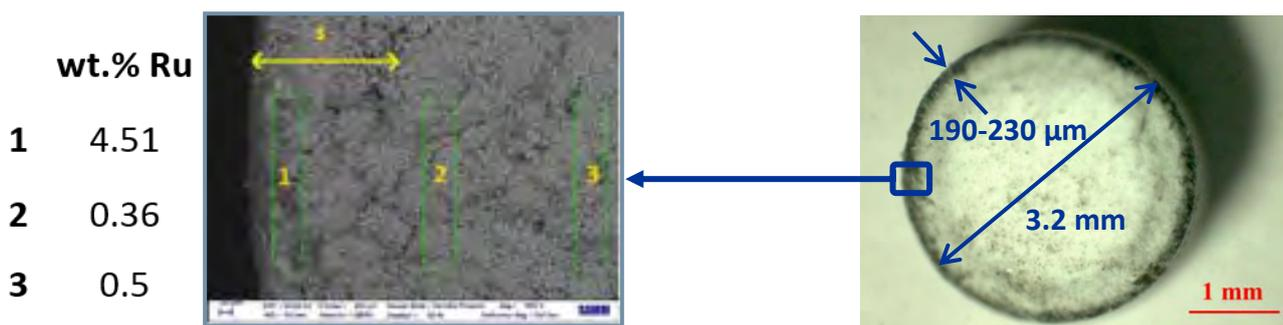
Figura 4: Microscopia ottica ed elettronica con analisi SEM/EDS su catalizzatore 0.5Ru/Al<sub>2</sub>O<sub>3</sub> (206199 ALDRICH)
