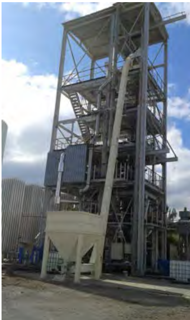
Figura 1. Sistema di caricamento automatico del combustibile "Redler"
