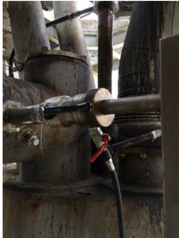
Figura 10. Sonda di campionamento riscaldata
