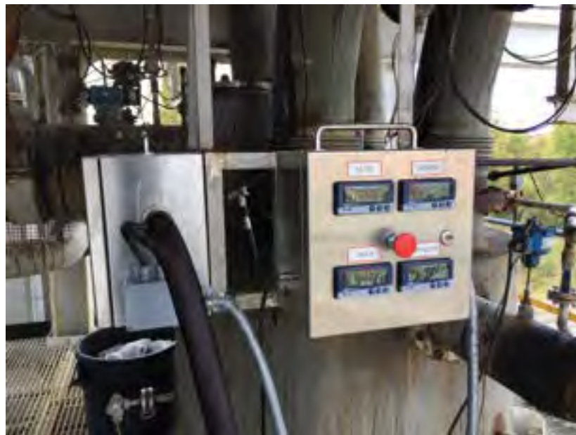
Figura 11. Sistema di termoregolazione per sonda, filtri, impinger e linea
