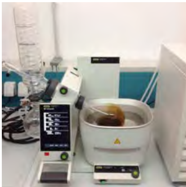
Figura 34. Evaporatore rotante Rotovapor per la separazione del TAR
