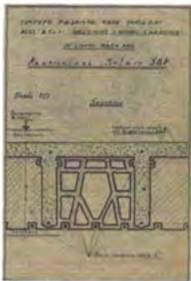
2.5 Disegno esecutivo dell'epoca del solaio SAP.
