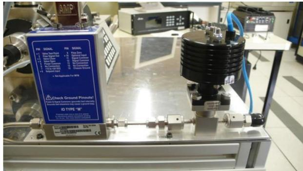
**Fig.b.1.3, sistema di ingresso dei gas, misuratore di flusso e valvola di sicurezza.**
