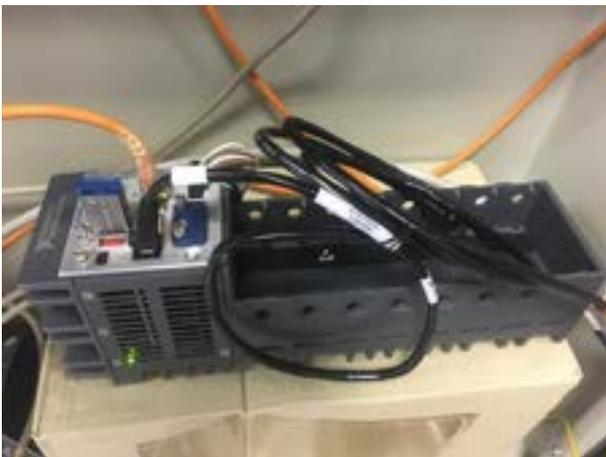
**Figura 12.** Il cRIO 9035 installato e collegato via Modbus al PLC della turbina a gas.
