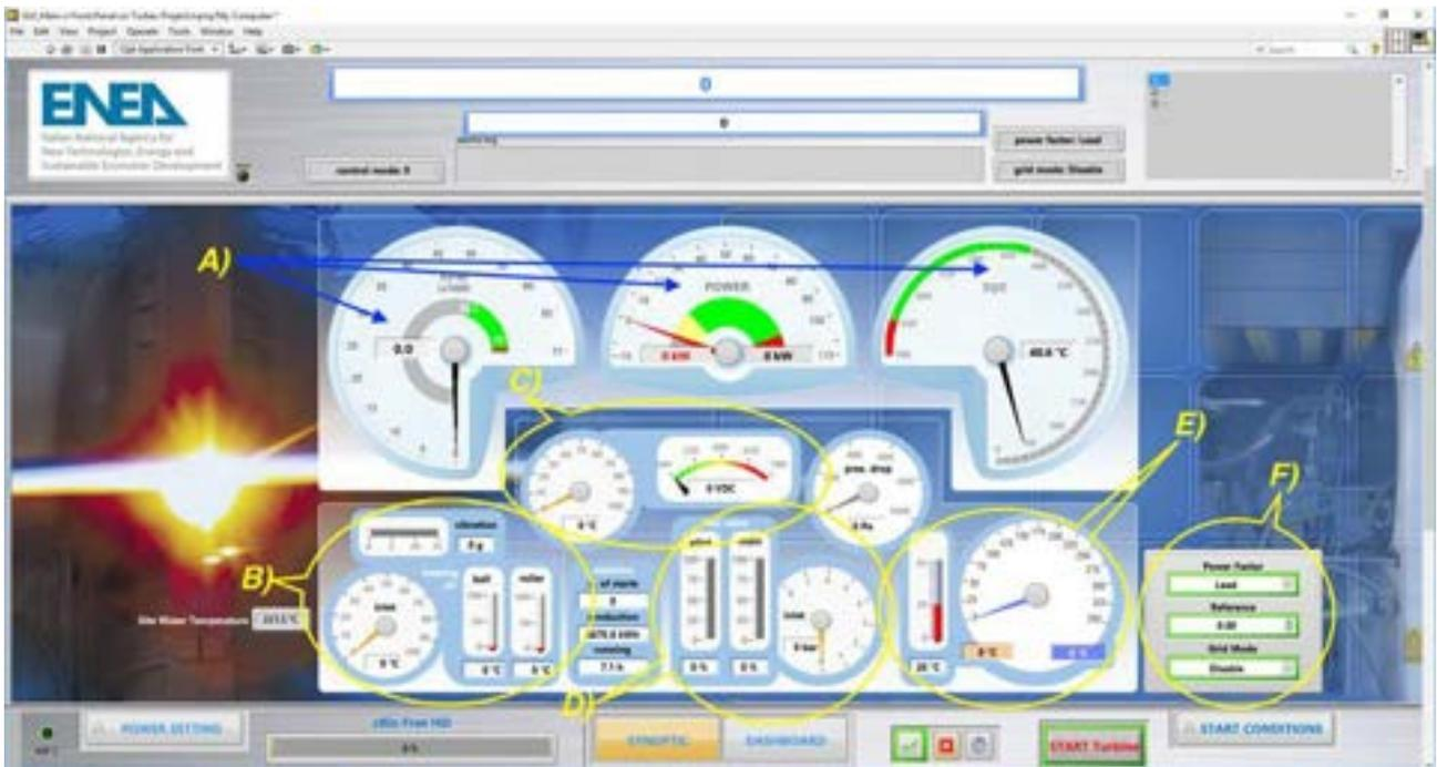
Figura 15. Dashboard Tab. Area A: indicatori principali (RPM, Power e TOT). Area B: indicatori bearings. Area C: indicatori generatore elettrico. Area D: indicatori sistema di alimentazione del combustibile. Area E: indicatori esausti turbina. Area F: Set-points.
