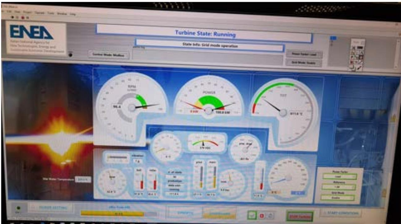
Figura 16. Vista della Dashboard Tab durante uno dei test “a caldo” del sistema di controllo implementato in cRIO.
