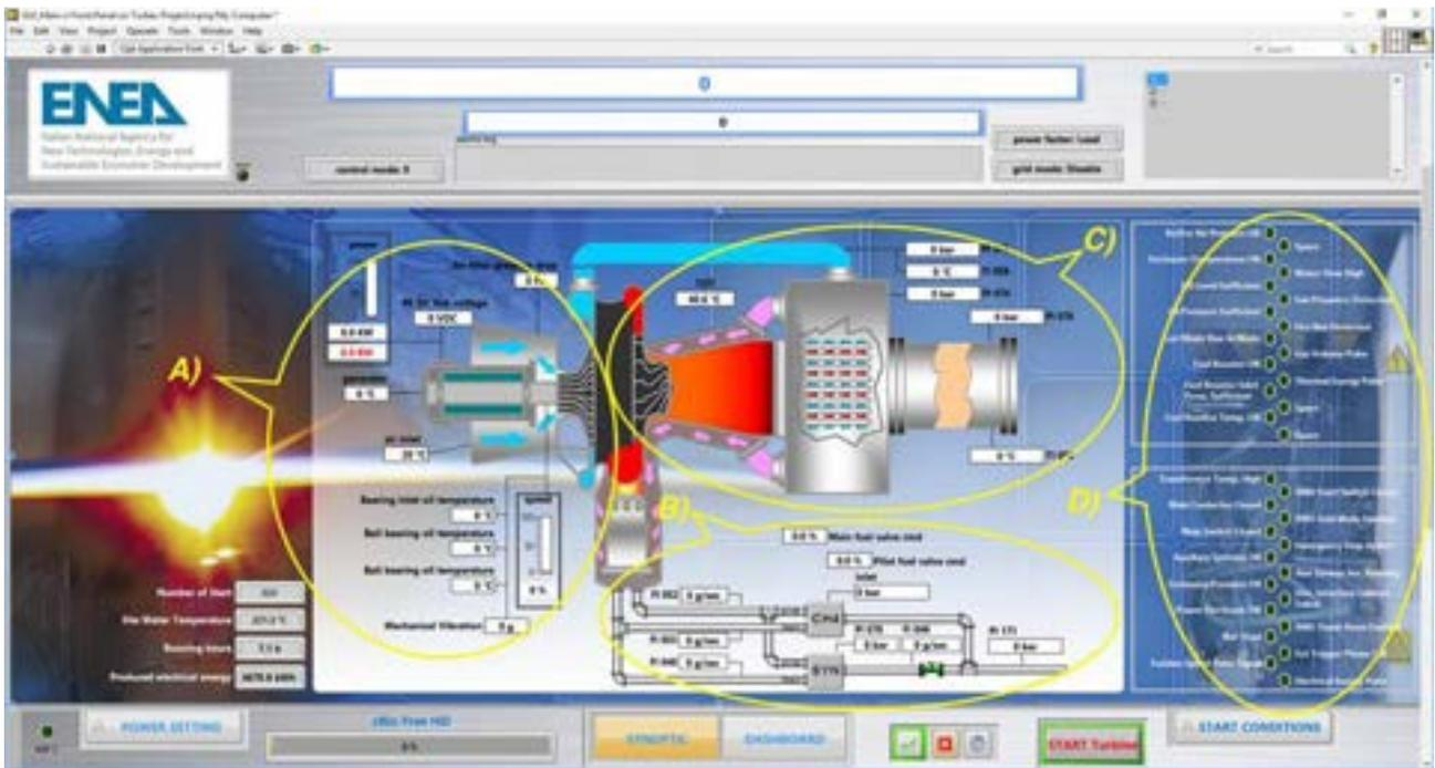
Figura 14. Synoptic Tab. Area A: variabili del generatore elettrico. Area B: variabili del sistema di alimentazione. Area C: variabili del ciclo termodinamico. Area D: allarmi.
