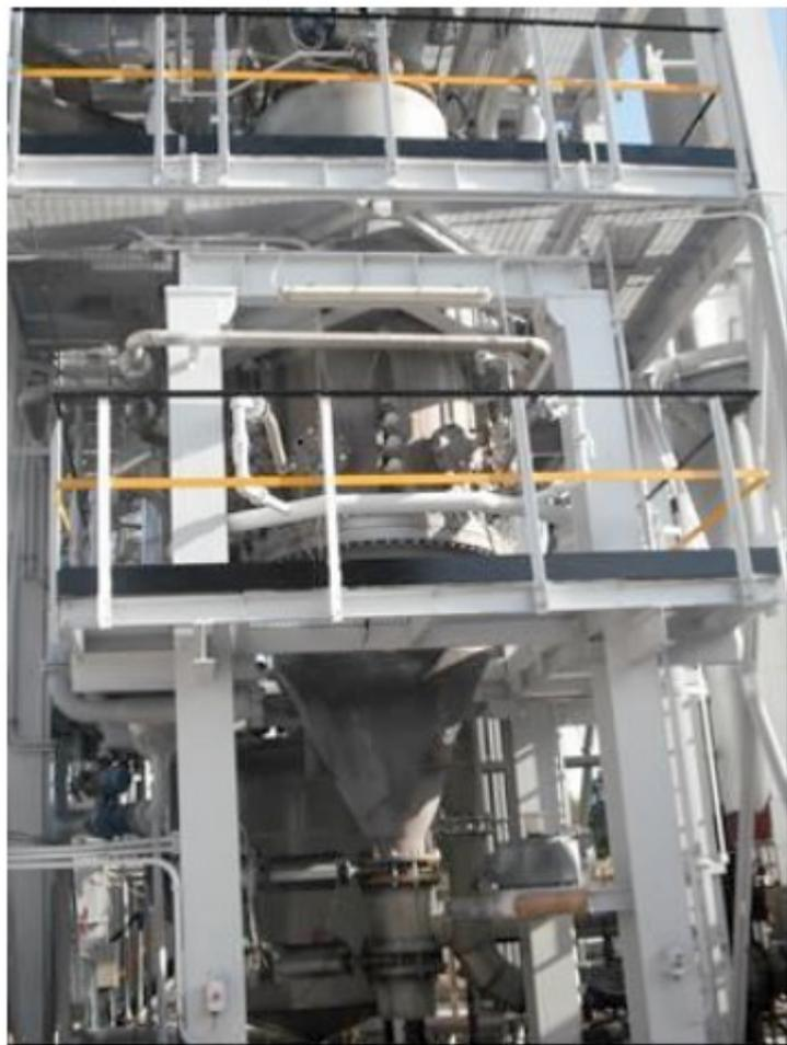
Figura 2. Gassificatore impianto dimostrativo
