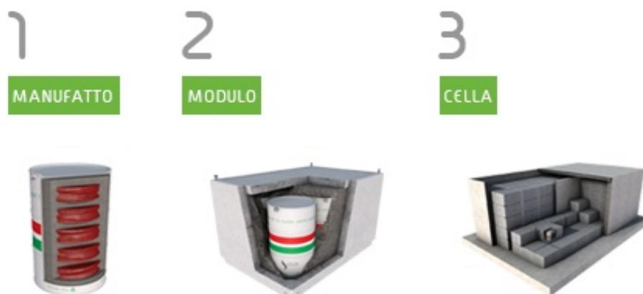
**Figura 6: Organizzazione gerarchica delle strutture di contenimento.**
