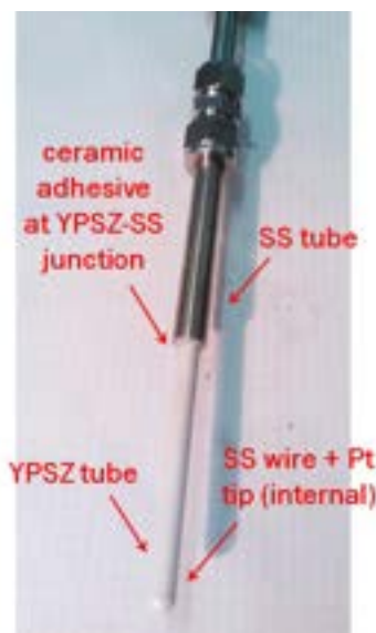
Figura 1: Sensore Pt-aria (850 mm) con adesivo ceramico alla giunzione YPSZ-SS (sensore 1).
