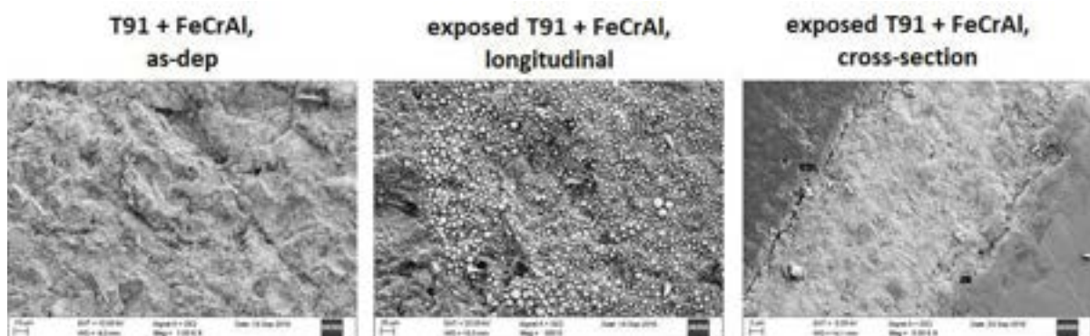
Figura 10: Trattamento superficiale tipo FeCrAl su acciaio T91 esposto in Pb statico a 550°C con basso ossigeno disciolto ( 10^{-8} % in peso) per 1500 ore [21].
