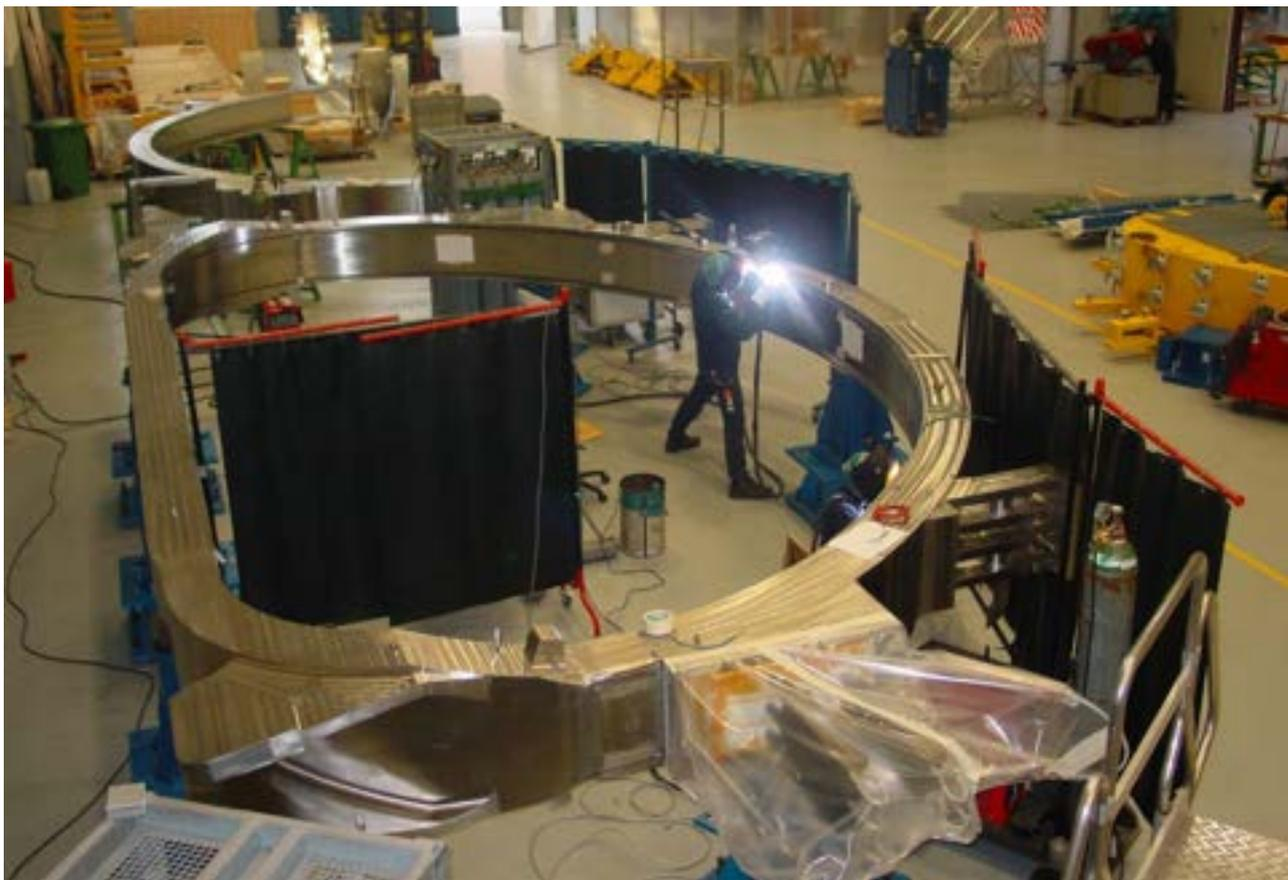
**Figura 6 Saldatura di riempimento del cianfrino del coperchio della TFC-02**
