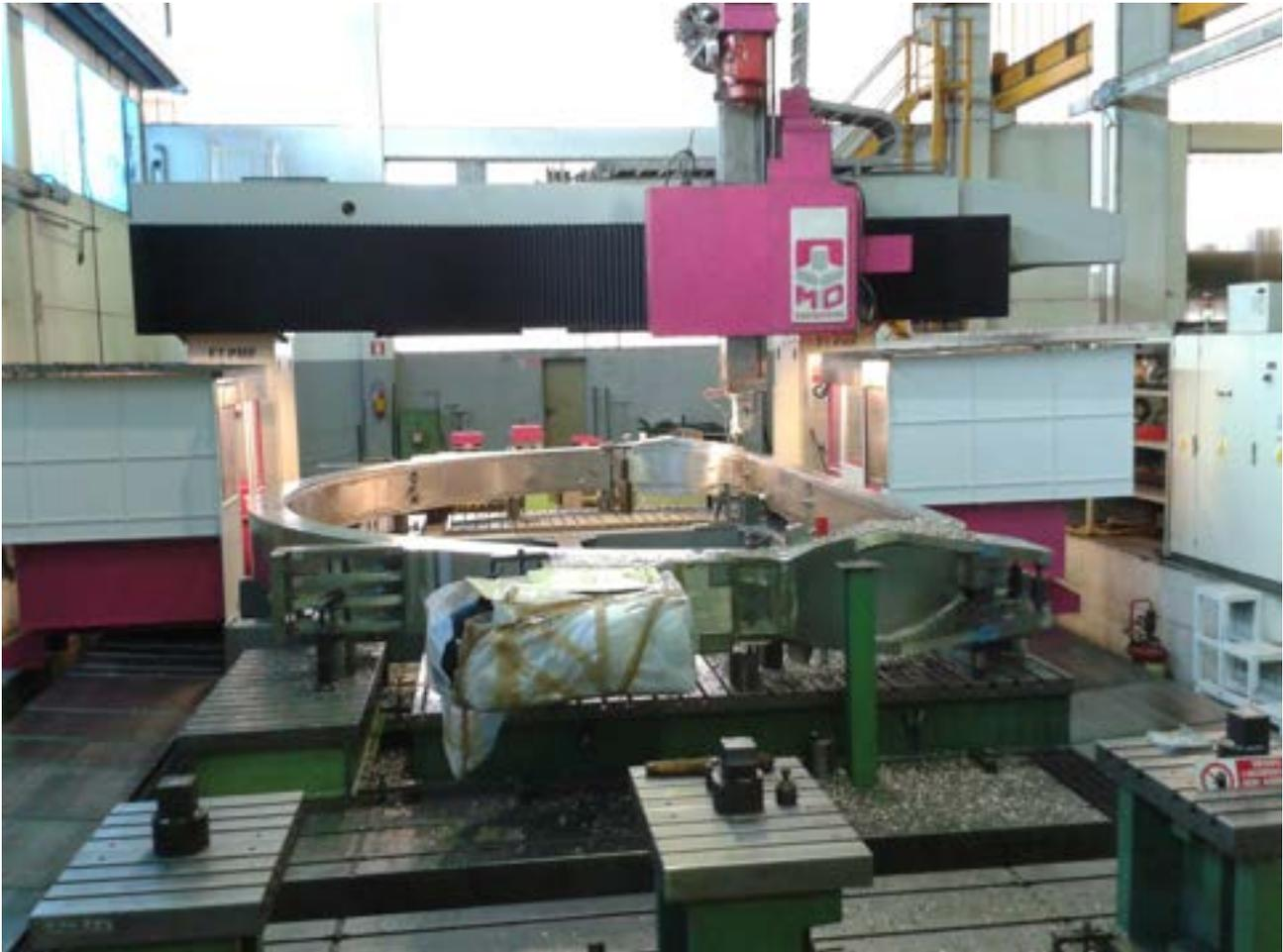
**Figura 13** Lavorazione della superficie di *wedging*
