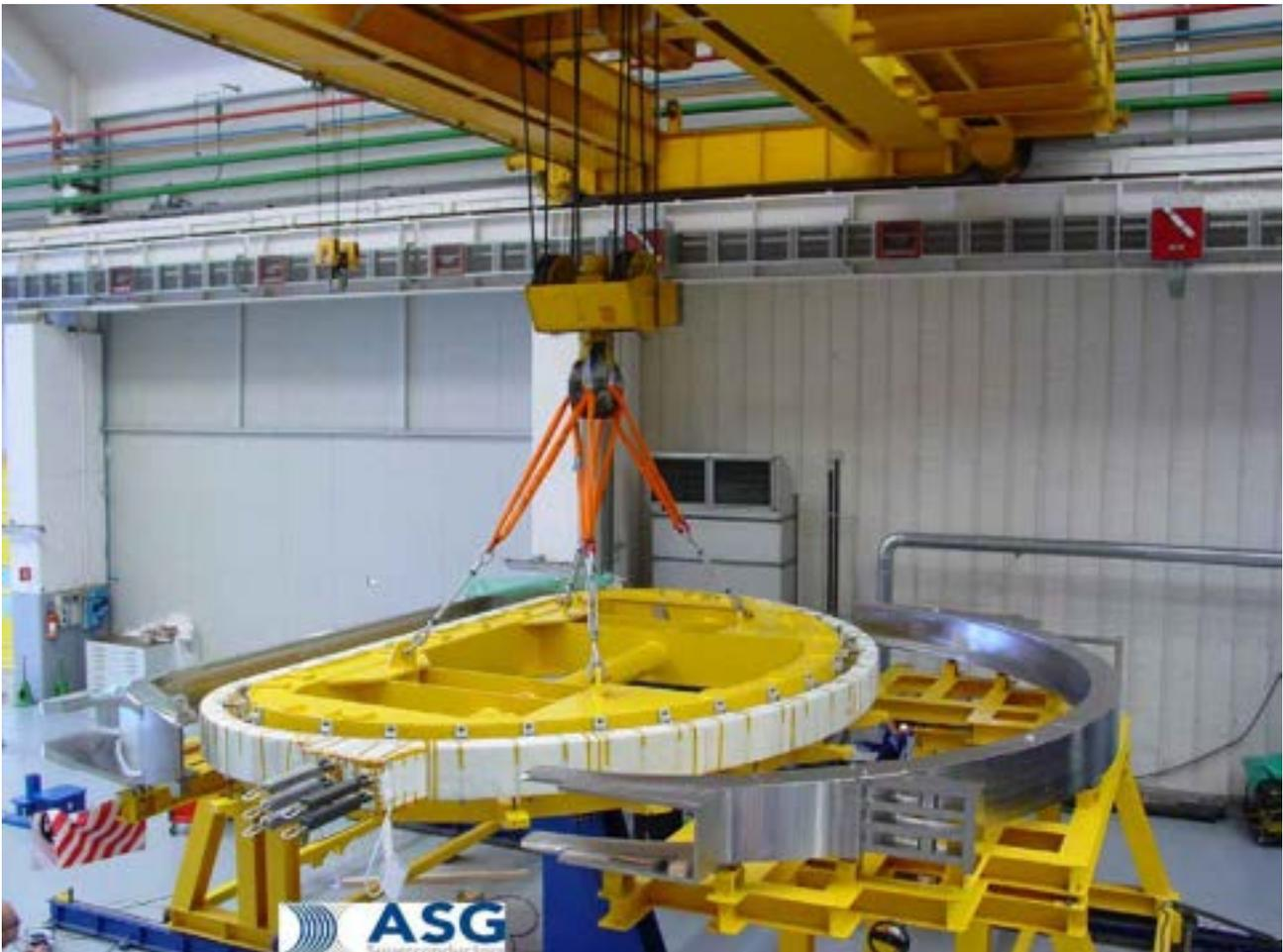
**Figura 3** Introduzione WP nell'attrezzatura di inserimento
