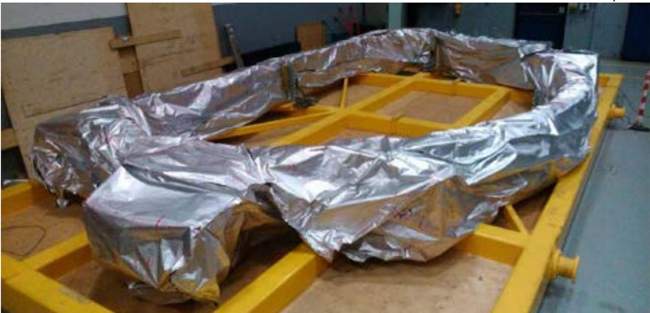
Figura 12 Modulo su telaio di trasporto per spedizione all'impresa responsabile delle lavorazioni di macchina
