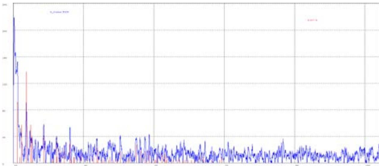
**Figura 1. La linea azzurra mostra il diffrattogramma relativo al campione di zolfo nanostrutturato. In rosso sono riportati i picchi relativi allo zolfo nella forma allotropica rombica ( $\alpha$ -zolfo).**
