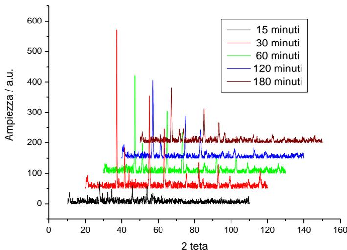
**Figura 12. diffratogramma dei materiali ottenuto tramite ball milling di zolfo e nitrato di litio per differenti durate del trattamento. Il tempo del trattamento è riportato nel grafico.**
