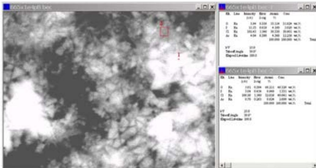
**Figura 7. Analisi EDX puntuale dello zolfo colloidale in presenza di PVP.**
