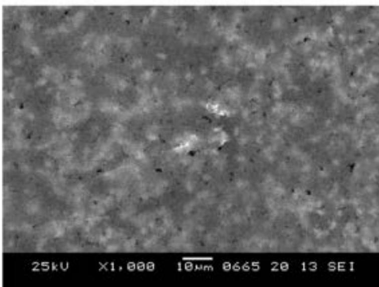
Figura 5. Immagine SEM dello zolfo prodotto mediante precipitazione da soluzione colloidale e ricoperto da PVP a 1000 ingrandimenti.
