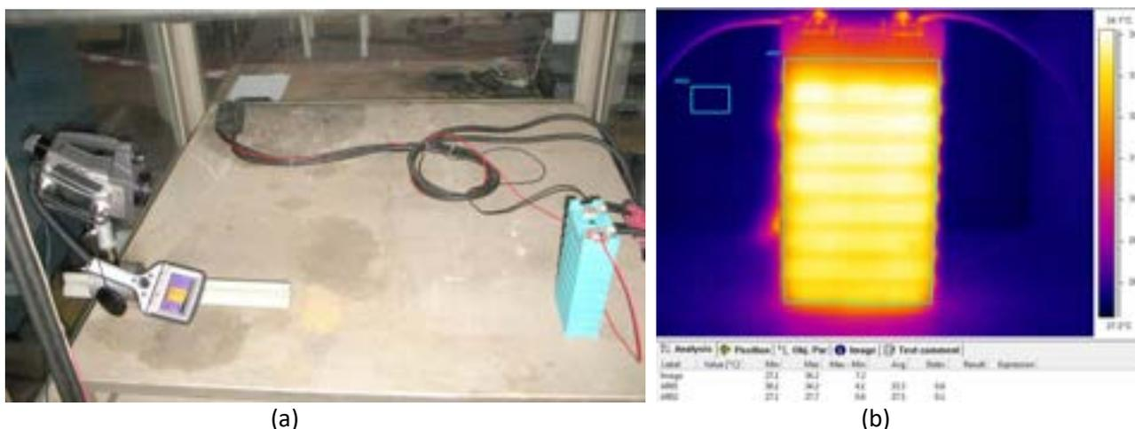
Figura 4. (a) Disposizione della termocamera; (b) Tipica immagine termografica elaborata, con le aree di interesse, durante una fase di scarica
