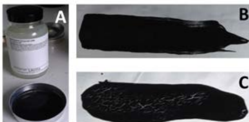
Figura 2: test di valutazione delle caratteristiche di bagnabilità del disperdente Hypermer (Croda) in H 2 O e mix S/Carbone nel pannello A, e stese della sospensione elettrodica mediante ottavino prima (B) e dopo 12 h di essiccamento sotto cappa a temperatura ambiente (C).
