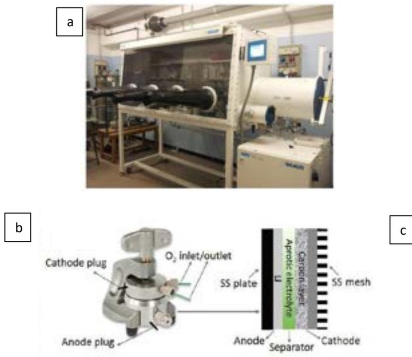
Figura 3. a) Immagine della Glove box usata per l assemblaggio e disassemblaggio delle celle; b) cella di test tipo ELCELL; c) schema di composizione dell elettrodo positivo.
