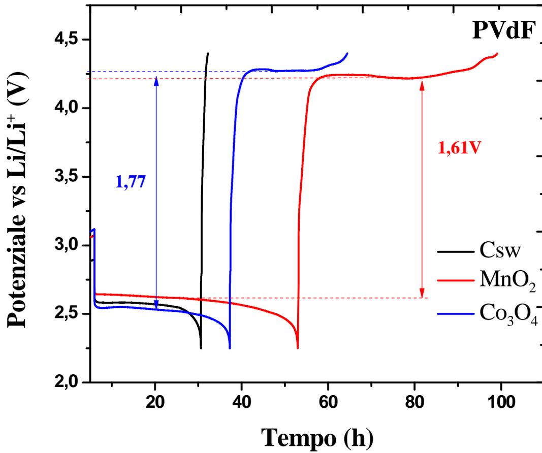
Figura 5. Curve voltammetriche del primo ciclo di scarica e ricarica per celle Li-Aria con elettrodo positivo con e senza catalizzatore e PVdF come legante.
