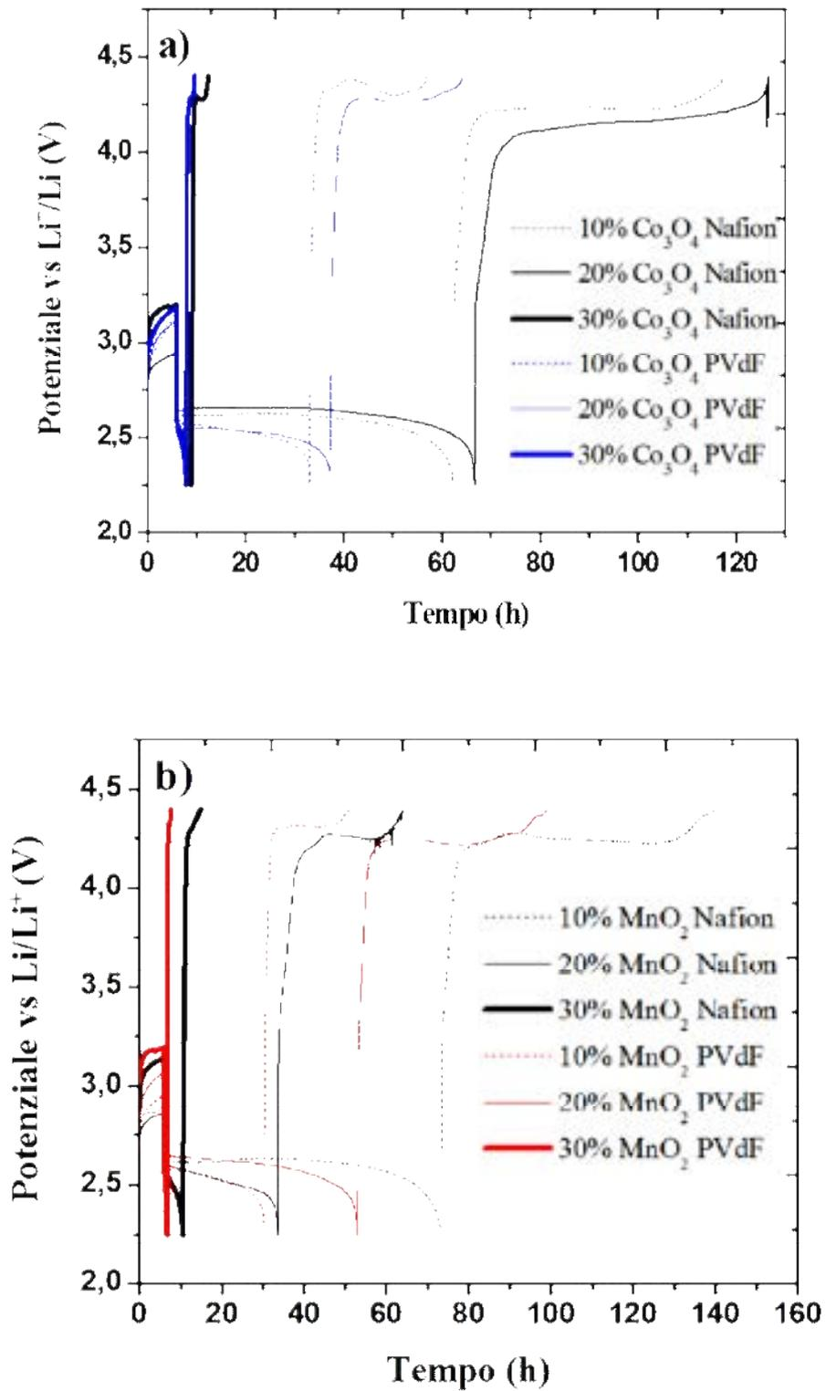
Figura 4. Profili del potenziale di cella per il primo ciclo scarica carica galvanostatica. a) per varie percentuali di  $\text{Co}_3\text{O}_4$  con PVdF e Li-Nafion come binder; b) per varie percentuali di  $\text{MnO}_2$  con PVdF e Li-Nafion come binder.
