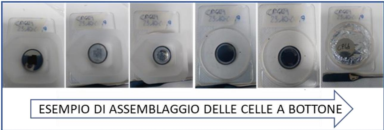
Figura 4. Foto delle varie fasi di assemblaggio delle celle sperimentali.
