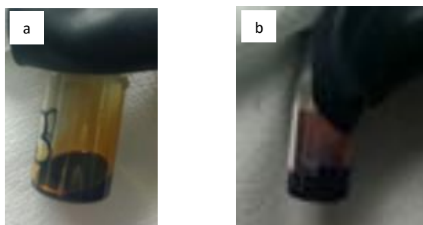
Figura 17. a) Soluzione di polisolfuri in DOL:DME (1:1) b) Elettrolita composto da DOL:DMSO (1:1).
