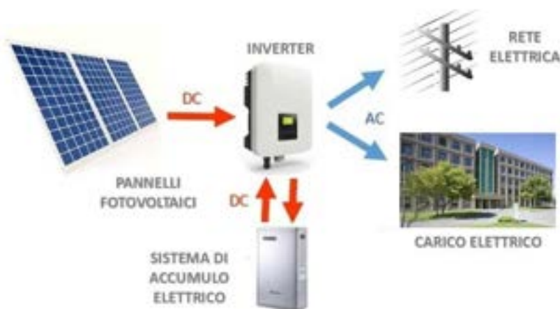
Figura 6 –Layout del sistema ibrido HRES per integrazione delle fonti rinnovabili.
