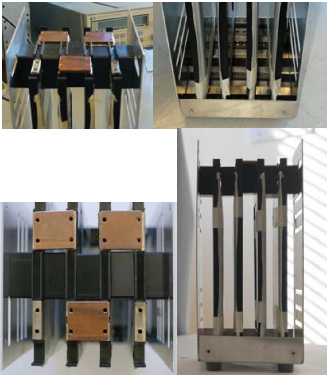
Figura 28. Montaggio meccanico ed elettrico delle celle elementari
