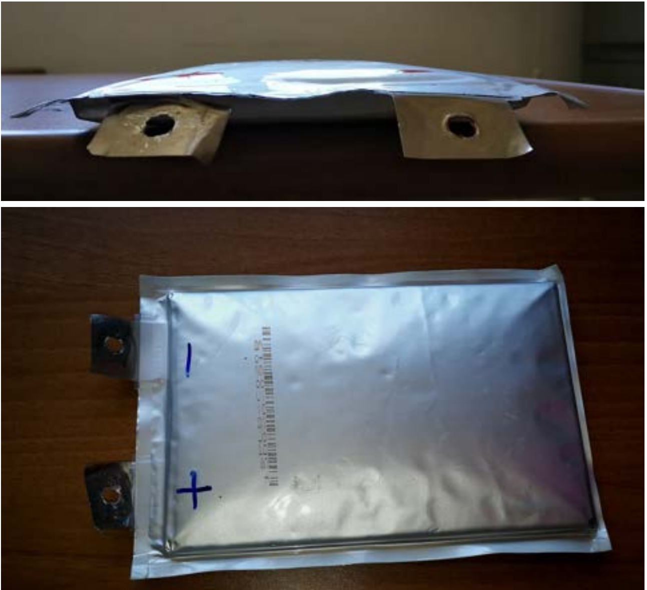
Figura 12. Deformazione di una cella in bustina
