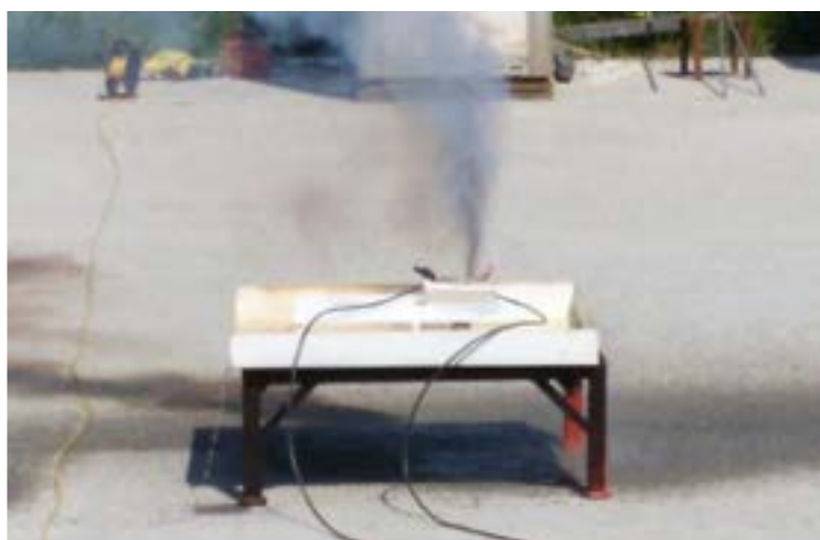
Figura 13. Venting di una cella
