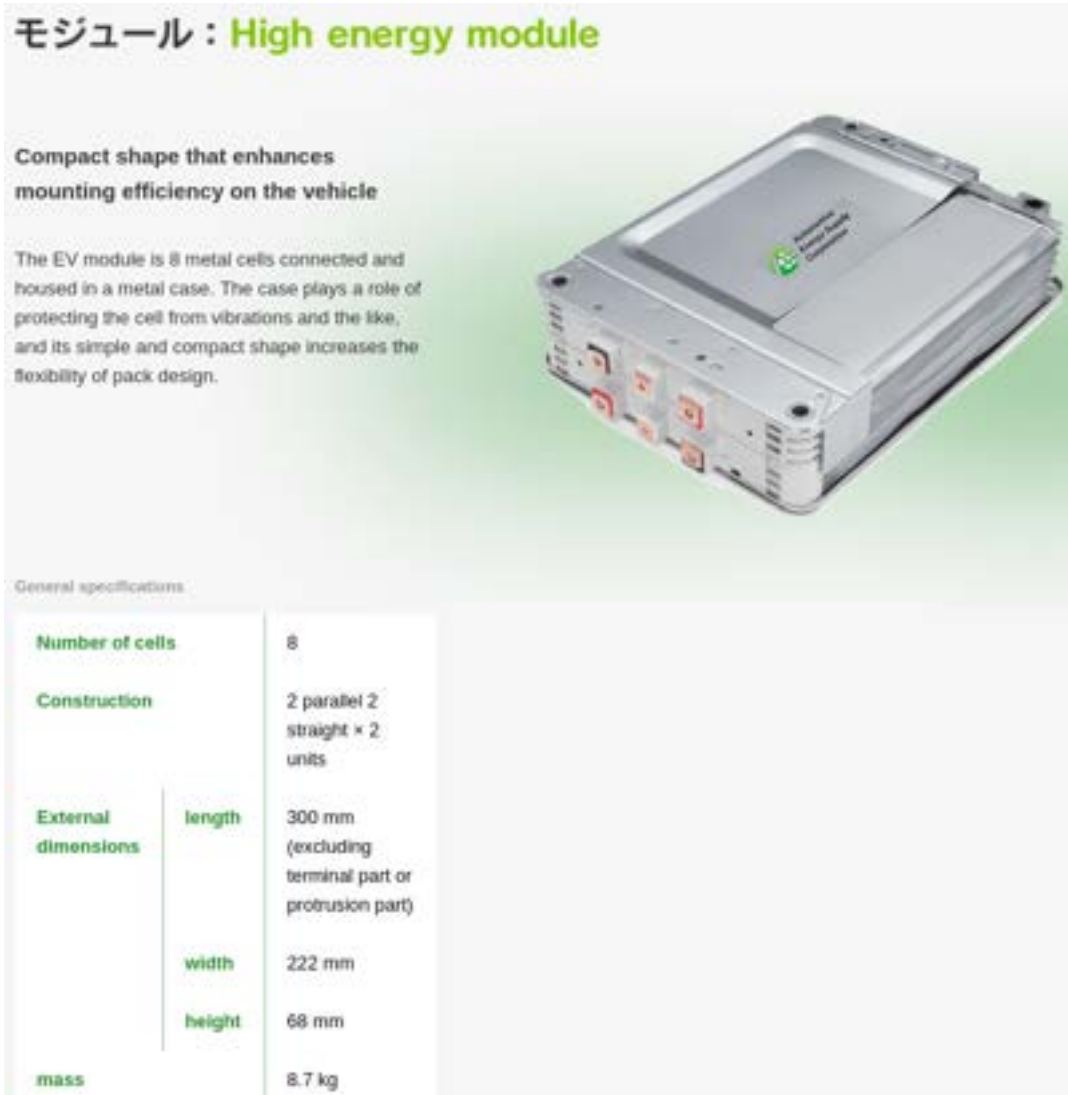
Figura 31. Modulo base della Nissan Leaf
