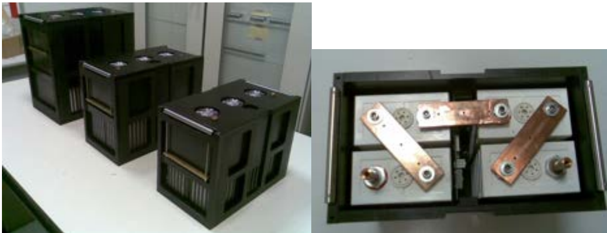
Figura 8. Moduli di celle prodotti da Enea a) vista d'insieme b) Spazi interni e connessioni di potenza
