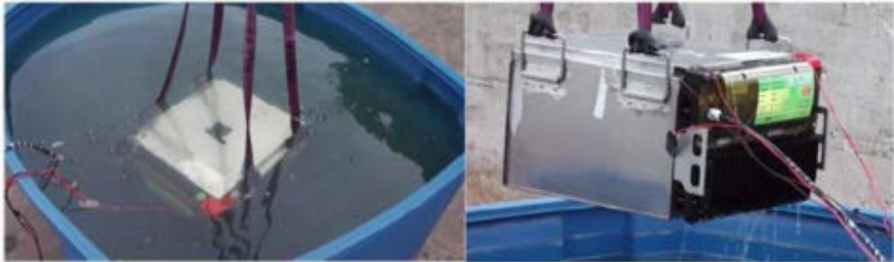
Figura 8. P6. Immersione in acqua salata
