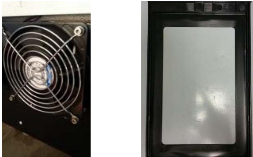
Figura 5. Griglia di protezione delle ventole e porta celle
