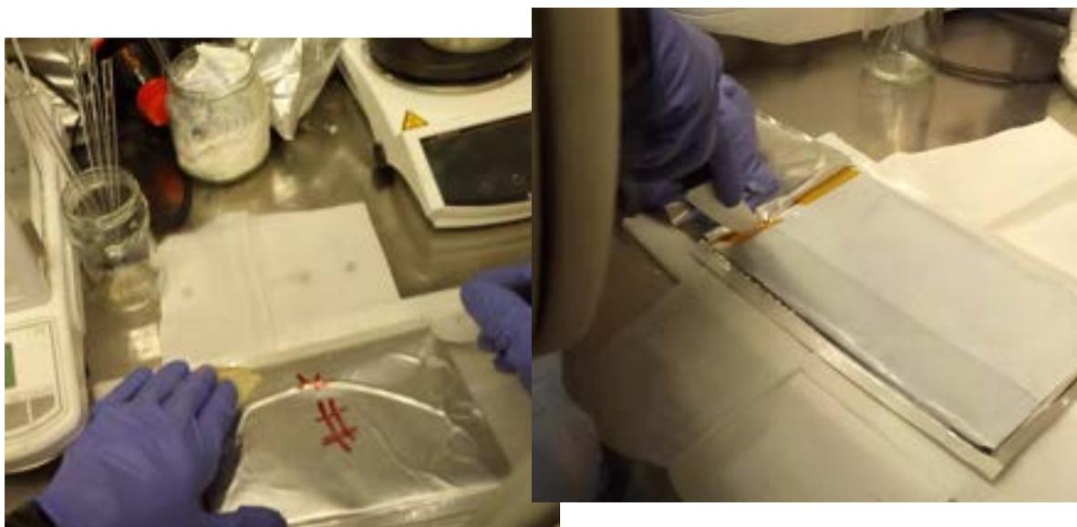
Figura 56 Apertura delle celle EiG-C020 nel glove-box.
