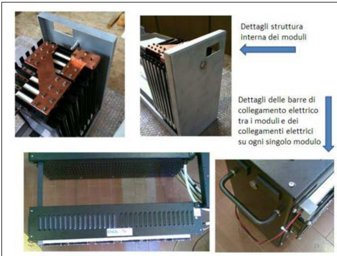
Figura 4. Dettagli del modulo batteria
