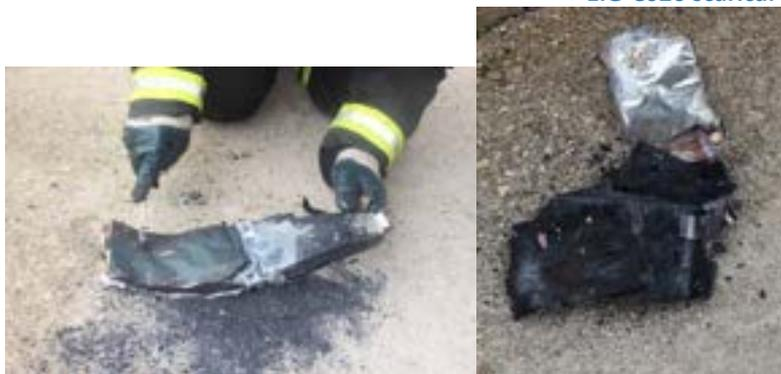
Figura 15 Residui di celle EiG-C020 dopo prove di incendio.
