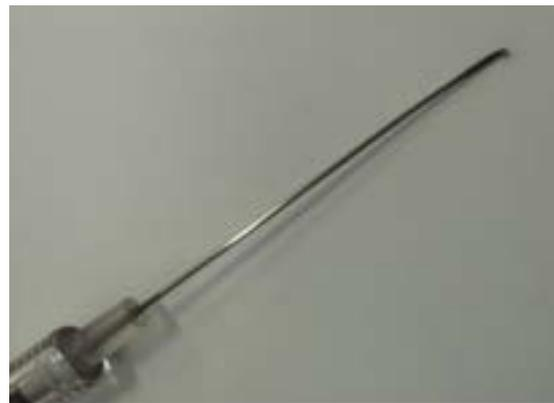
Figura 54 Ago della siringa da gas usata per il campionamento.
