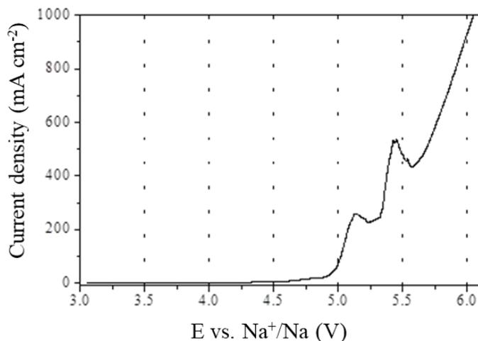
**Figura 2.** Profili ottenuti tramite voltammetria a scansione lineare, eseguita a 45 °C, per gli elettroliti basati su PEO e RTILs oggetto di studio; velocità di scansione: 0.1 mV s<sup>-1</sup>.
