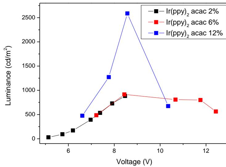
Figura 9: Curve EL dispositivi con Ir(ppy)<sub>2</sub>acac
