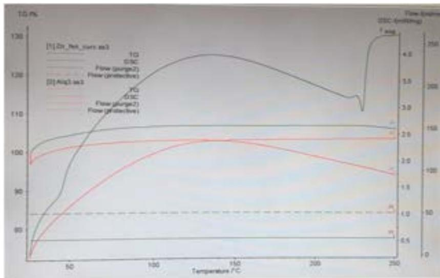
Figura 15: Caratterizzazione DSC del complesso dello zinco
