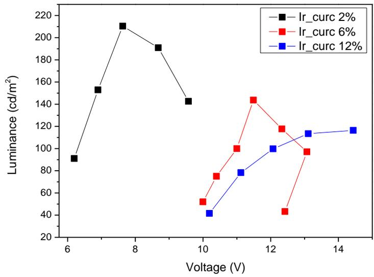
Figura 7: Curve EL dispositivi con Ir\_curc
