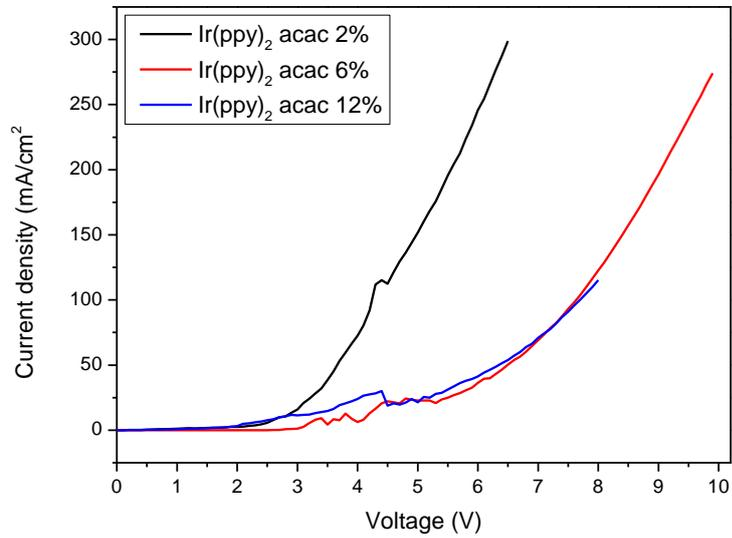
Figura 8: Curve IV dispositivi con Ir(ppy)<sub>2</sub>acac
