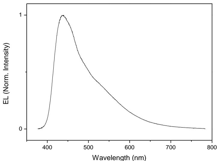
**Figura 16: Spettro di elettroluminescenza dispositivo ITO/PEDOT:PSS/NPD/ComplessoZinco/BCP/Alq<sub>3</sub>/Ca/Ag**
