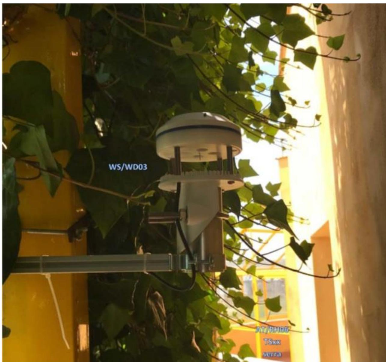
Figura 3 disposizione dei sensori all'interno dell'intercapedine verde della parete Sud-Ovest – piano secondo
