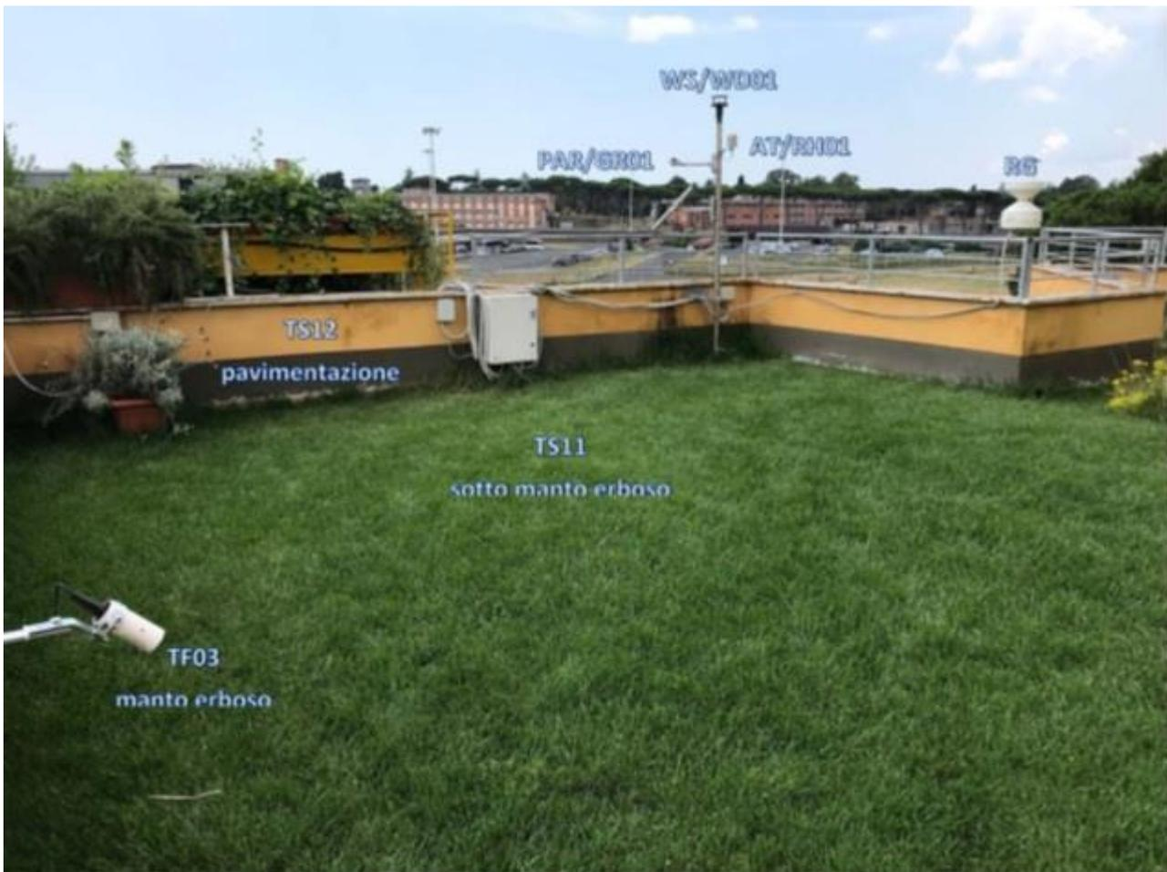
**Figura 10** Disposizione sensori sulla copertura a verde
