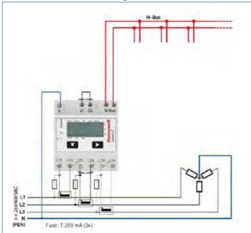
I dati relativi alla potenza termica ed elettrica associate alla macchina sono inviati mediante interfaccia M-BUS ad un data-logger che ne memorizza le misure.
