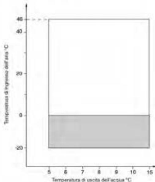
Nota: Salto termico attraverso lo scambiatore refrigerante-aria e lo scambiatore refrigerante-acqua = 5 K
