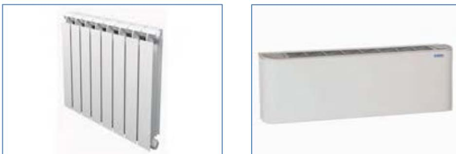
Nei fancoils l'aria prelevata dal locale, dopo essere stata filtrata, è inviata alla batteria di scambio (aria-acqua), nella quale, a seconda della stagione, assorbe o cede calore; successivamente, mediante il ventilatore elettrico viene diffusa nell'ambiente alla temperatura di set-point regolata (generalmente 20°C riscaldamento, 26°C climatizzazione estiva).
