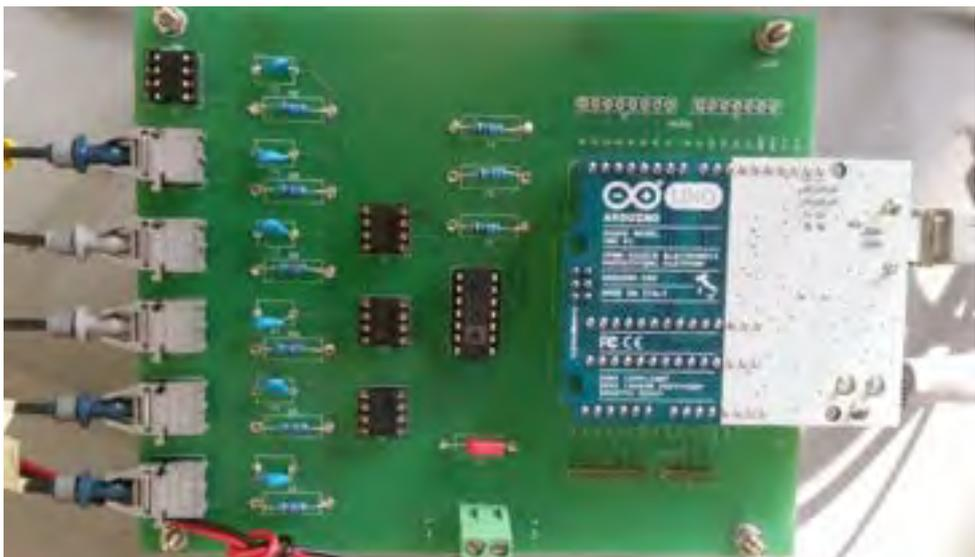
Figura 29. Scheda di controllo con microcontrollore Arduino.
