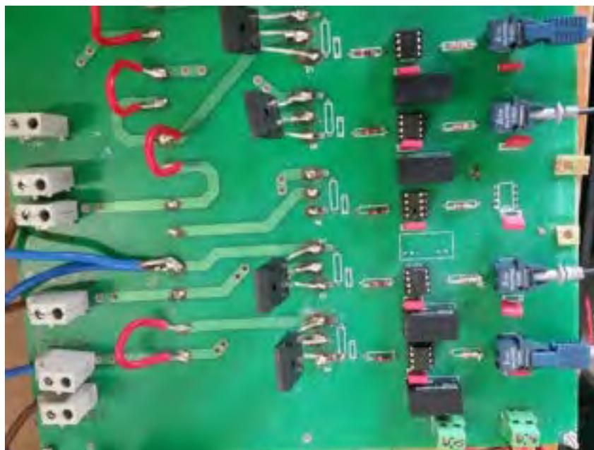
Figura 26. Scheda del primo stadio (Inverter a ponte intero).
