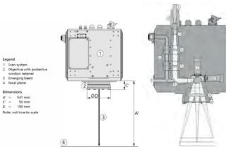
Figura 19: Schema della testa di saldatura remota Scanlab Intelliweld.
