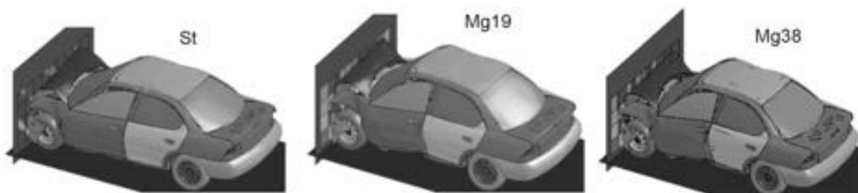
Figura 10: simulazioni di impatti in FFI (“full frontal impact”) per component strutturali in acciaio (a) e magnesio (19% e 38%, deformazione plastica a rottura) [28].
