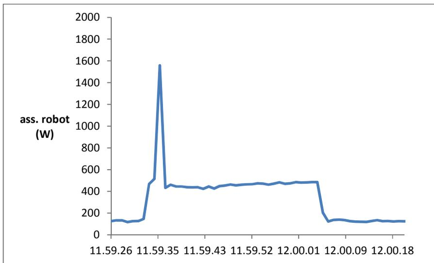
**Figura 32: Grafico di assorbimento del robot durante il processo di saldatura MIG**
