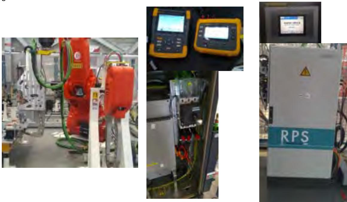
**Figura 38: Configurazione di misura per il sistema Robot e generatore di saldatura a Resistenza.**
