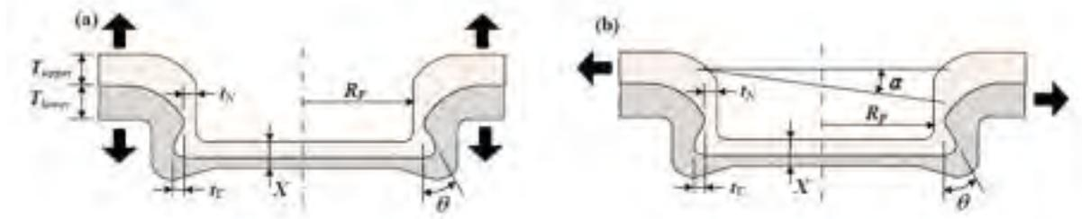
Figura 63: Valutazione della sezione efficace della giunzione per clinchiatura
