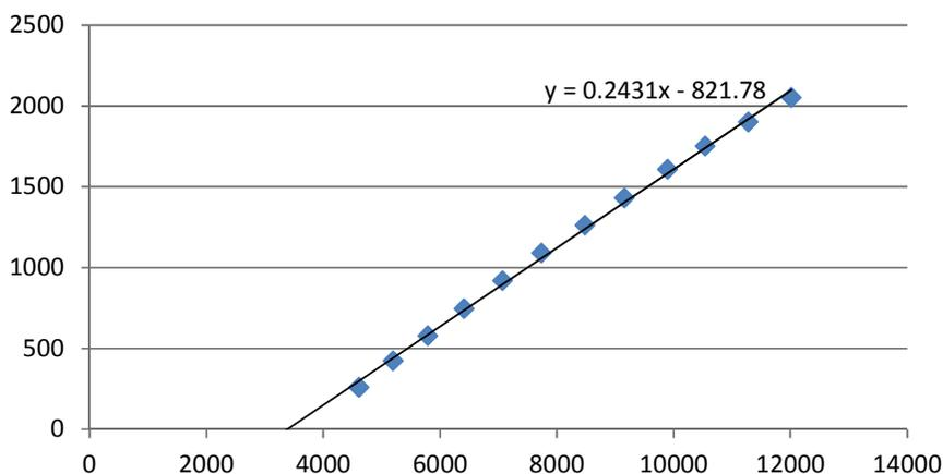
Figura 24: Curva potenza utile vs potenza assorbita. La pendenza definisce il rendimento della sorgente laser apparente (rendimento elettro ottico netto).
