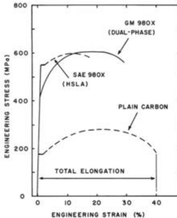
Figura 12: curva sforzo-deformazione per un acciaio DP (GM 980X) in confronto ad acciai plain-carbon e SAE 980X, basso legati ad alta resistenza (HSLA).
