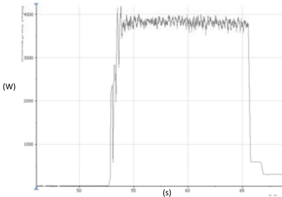
**Figura 33: Grafico di assorbimento del generatore di saldatura MIG**
