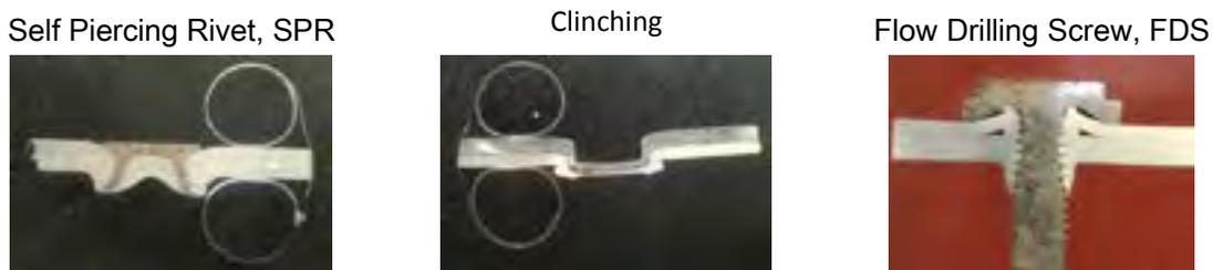
Figura 5– Sistemi di giunzione meccanica.
