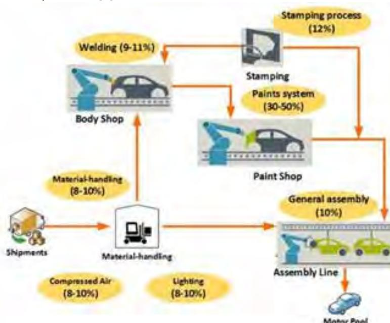
Figura 2– Incidenza energetica nel processo di produzione di un'automobile.
