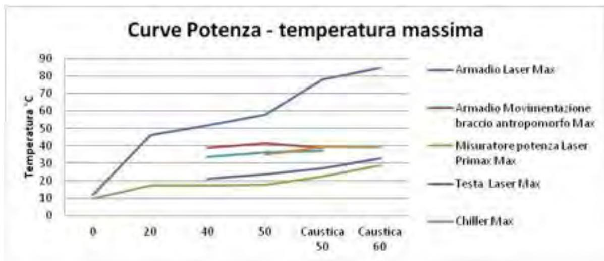
Figura 29 Grafico relazione potenza temperatura dei dispositivi.
