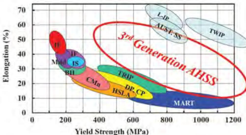
Figura 11: carico di snervamento in funzione della deformazione per alcuni tipi di acciai [28].
