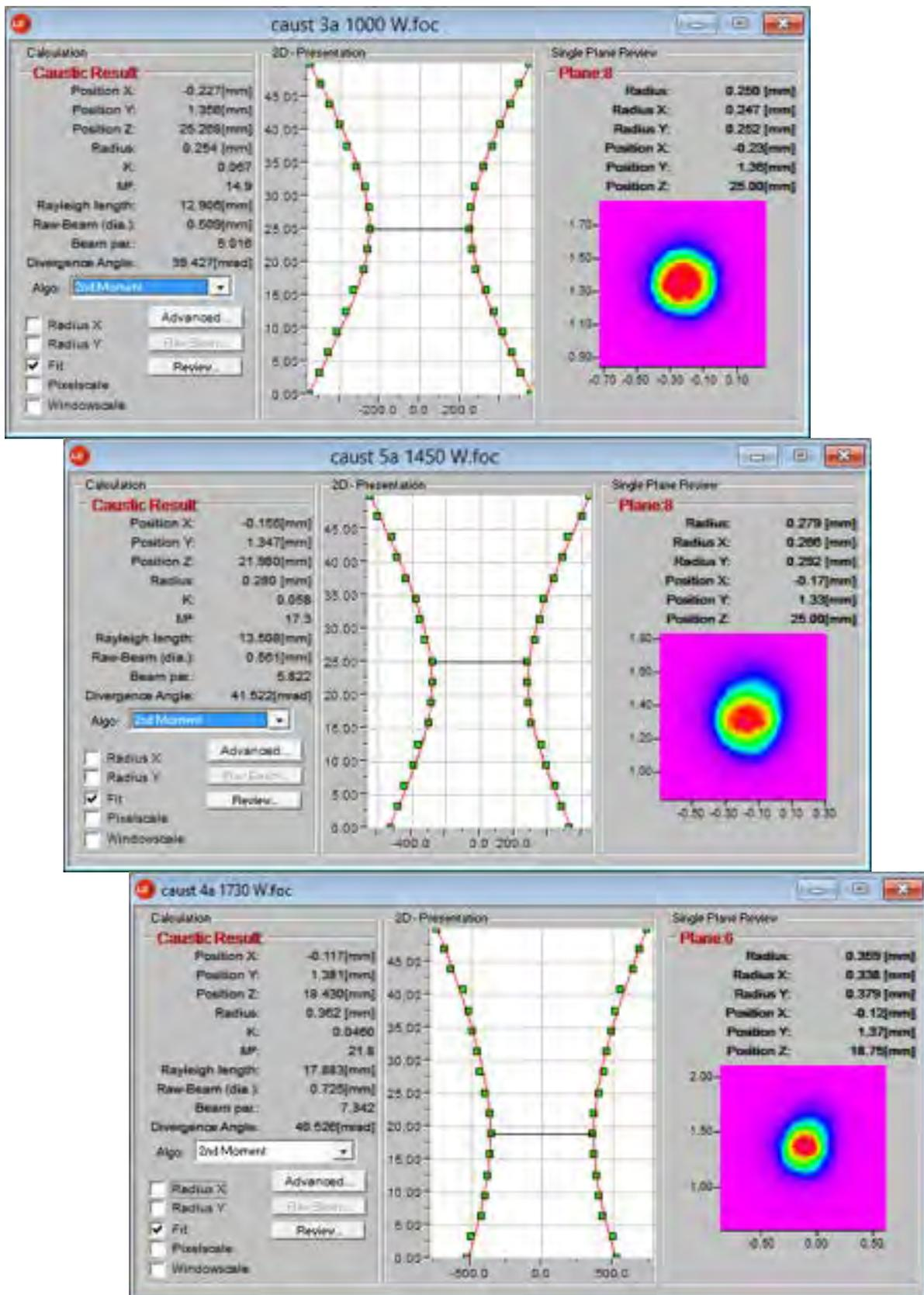
Figura 26: focalizzazione a diverse potenze (1,0, 1,45 e 1,73 kW).
