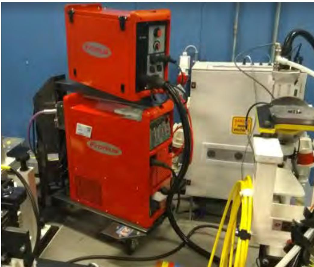
**Figura 31: Generatore MIG Fronius per saldobrasature in sovrapposizione.**
