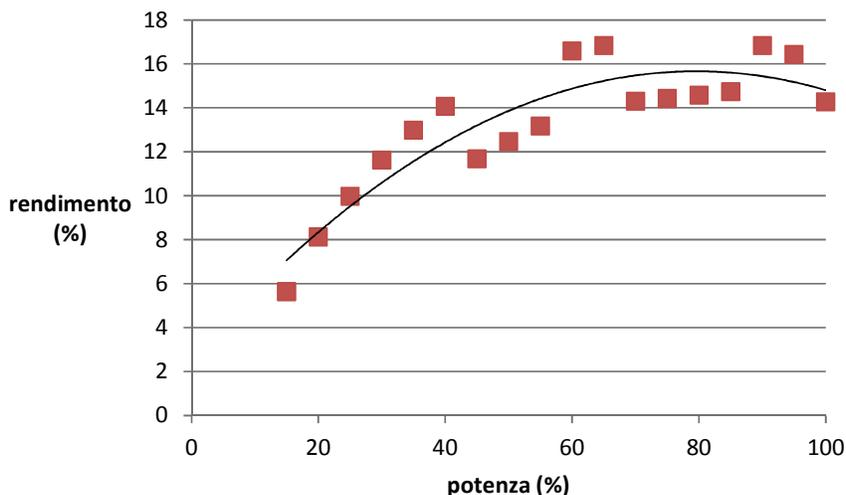
Figura 25: Andamento del rendimento reale (sia sorgente che percorso ottico) in funzione della percentuale di potenza nominale impostata.
