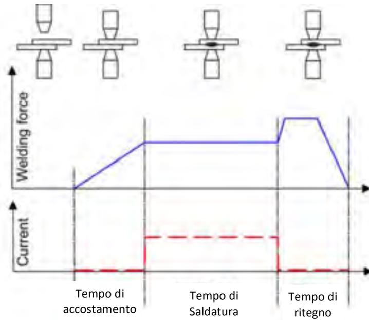
Figura 39: Rappresentazione di un ciclo standard di RSW.
