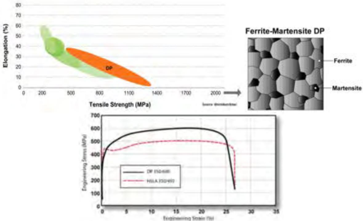
Figura 14: Le immagini riportano, per gli acciai DP l'area di applicazione (a sinistra, curva resistenza a trazione in funzione dell'elongazione), la microstruttura (al centro) che è alla base delle caratteristiche meccaniche migliorate, e un confronto con gli acciai HSLA, 350/450 (a destra, curva sforzo-deformazione) [33].
