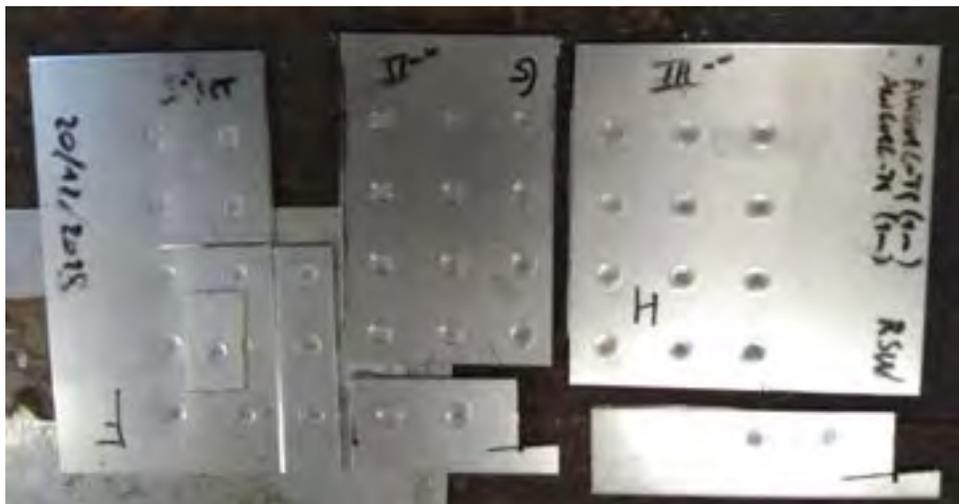
Figura 53: Piastra di AA6016 T6 saldata sezionata nei tre set di prove effettuate.
