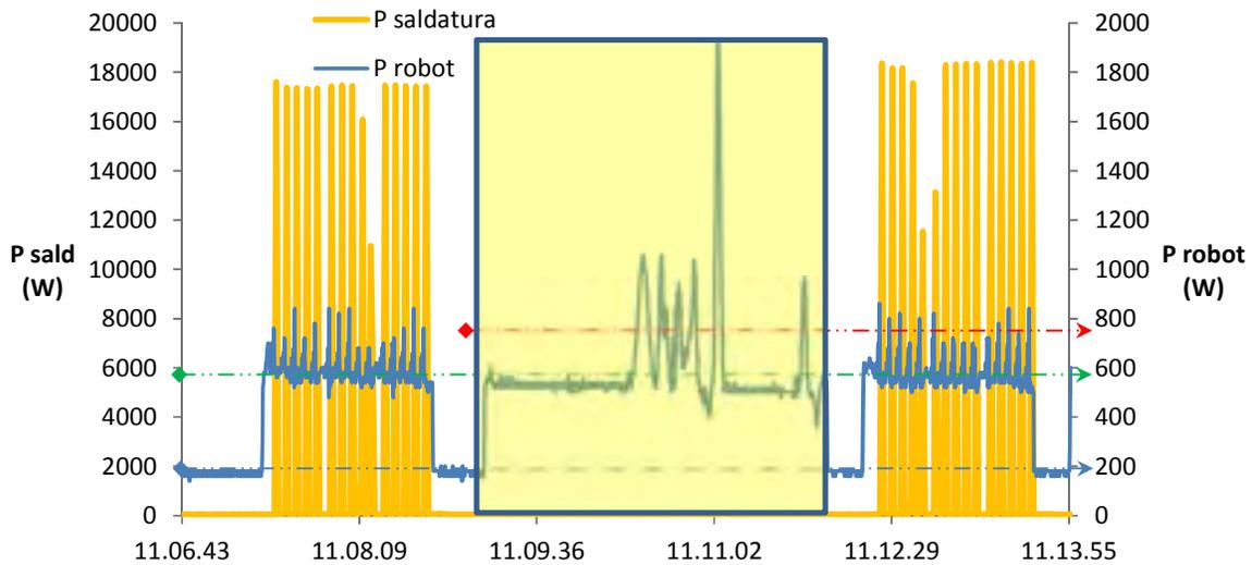
**Figura 43: Grafico complessivo dei consumi energetici del processo di saldatura RSW su alluminio**
