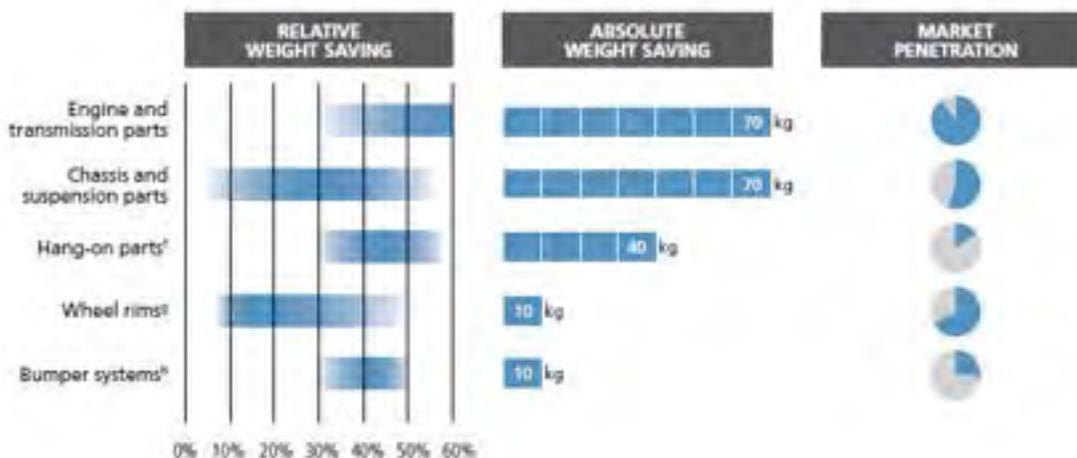
Figura 15: Riduzione di peso con maggiore impiego dell'alluminio e penetrazione nel mercato [5].
