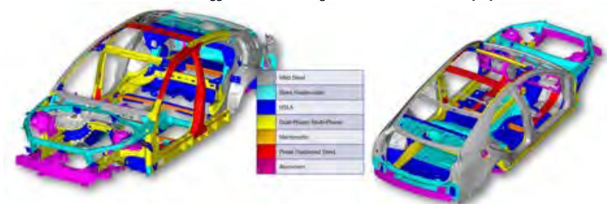
Figura 9: Materiali utilizzati all’interno di un veicolo Cadillac ATS ai fini dell’alleggerimento e della sicurezza.
