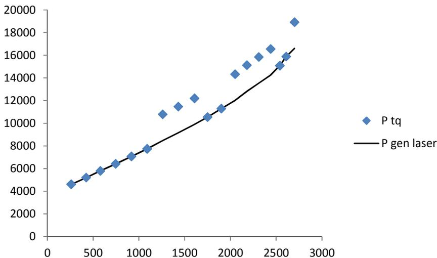
**Figura 23: Analisi del comportamento energetico della sorgente laser con discriminazione della curva di assorbimento della sola generazione laser in funzione della potenza effettivamente erogata.**
