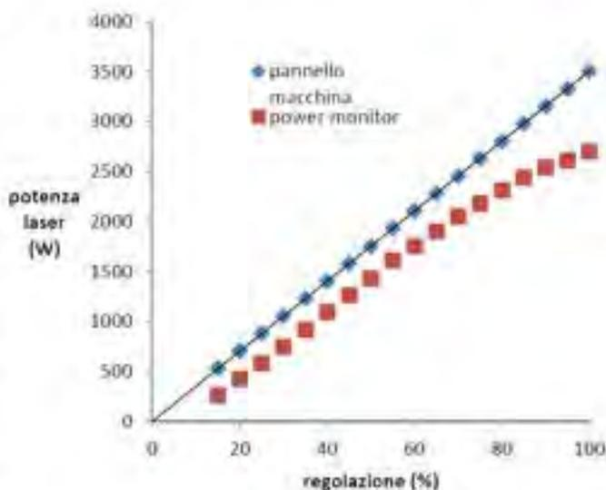
Figura 20: Confronto tra lettura a pannello e misura reale mediante calorimetro PM 48.
