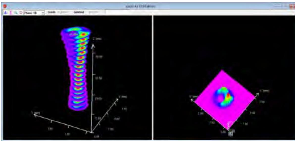
Figura 28: vista d'insieme della caustica a 1730 W. Profilo del fascio tipico di problemi di contaminazione a livello del collimatore.
