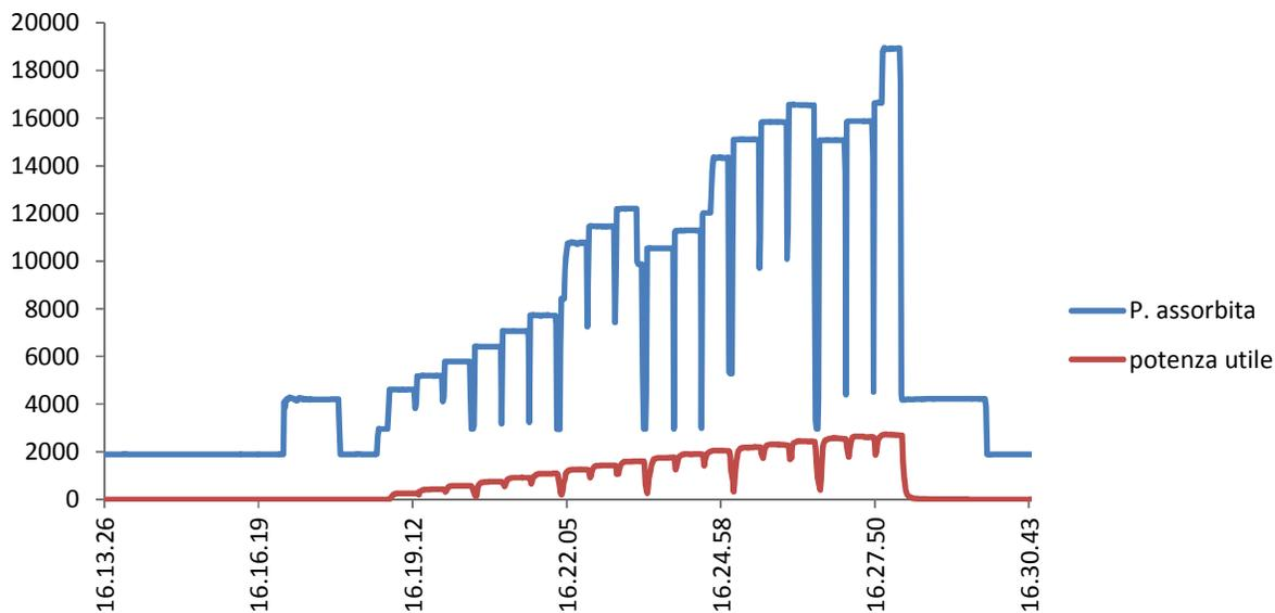
Figura 21: andamento dell'assorbimento della rete al variare della potenza laser utile durante l'esecuzione della curva di potenza.
