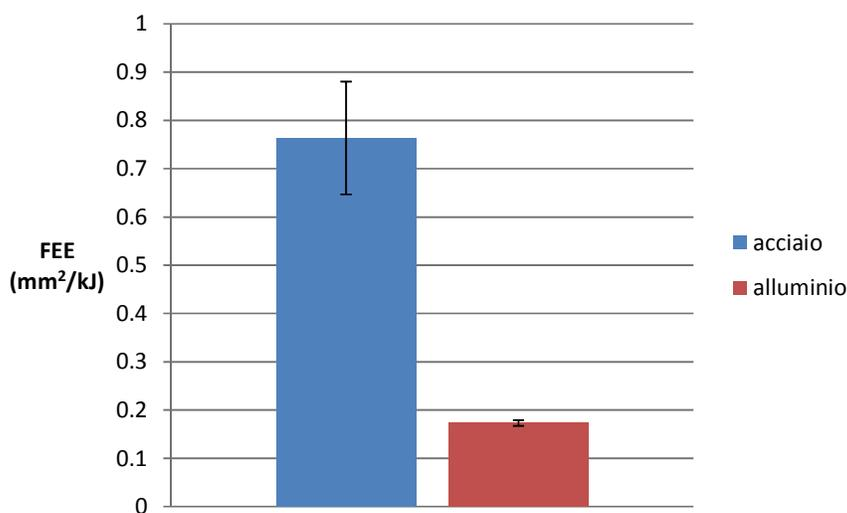
Figura 55: FEE a confronto fra RSW di acciaio ed Alluminio
