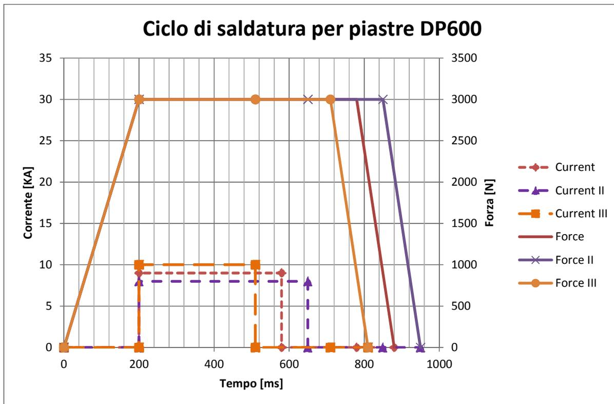
Figura 46: Grafico dell'andamento forza e corrente di saldatura per acciaio.
