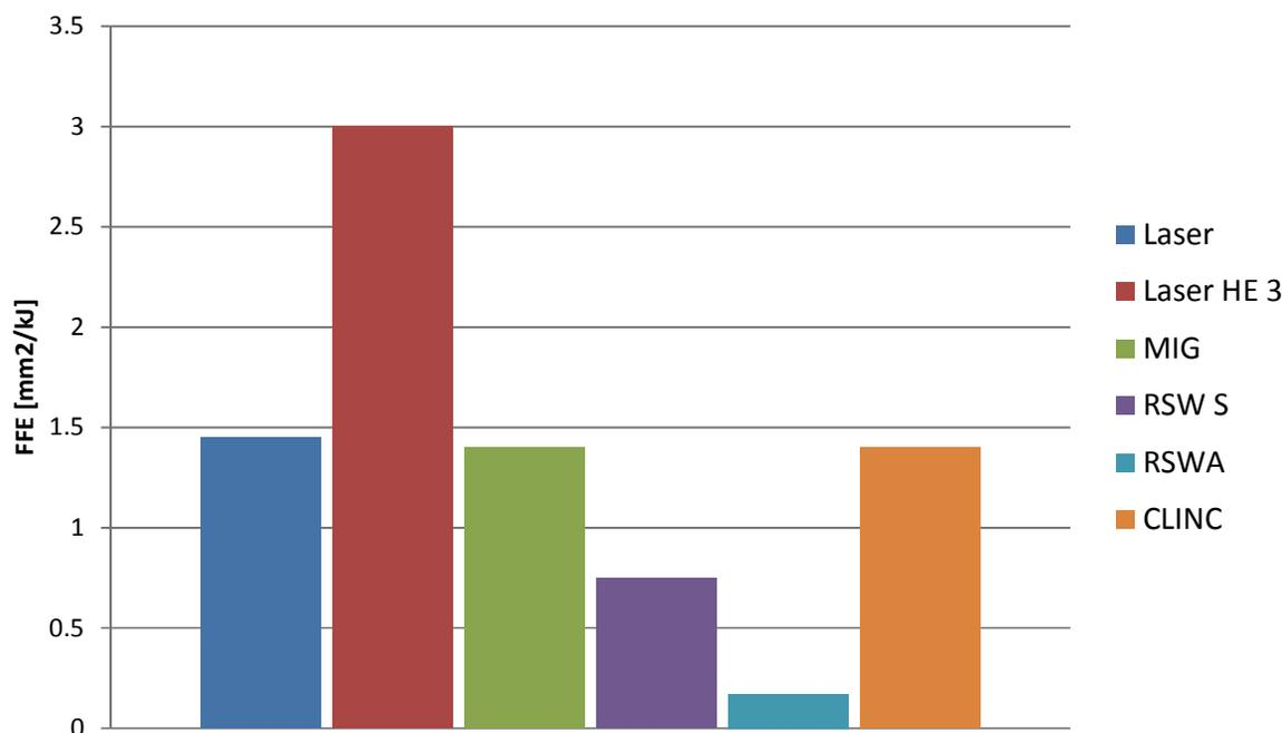
Figura 65: Confronto FEE dei processi analizzati nel settore Automotive
