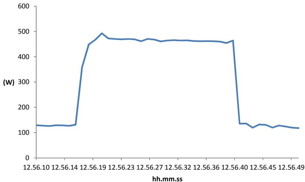
**Figura 30: Grafico di assorbimento del robot durante il processo di saldatura laser**
