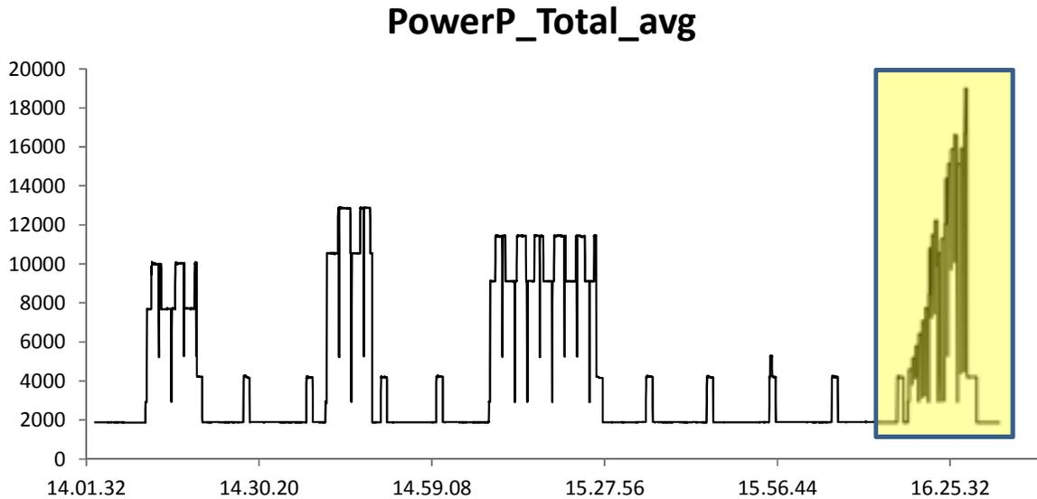
**Figura 22: Lettura complessiva della potenza istantanea misurata con Fluke 1738 durante tutte le prove. Evidenziata la porzione corrispondente alle fasi di misura della curva di potenza dal 15 al 100%.**
