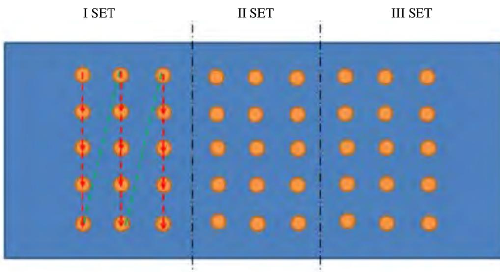
Figura 45: Sequenza di Saldatura.
