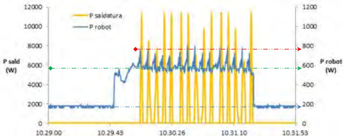
Figura 42: Grafico complessivo dei consumi energetici del processo di saldatura RSW su acciaio
