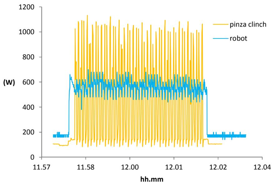
**Figura 58: Grafico complessivo dei consumi energetici fra pinza di "clinching" TOX e robot per l'intero ciclo di puntatura**
