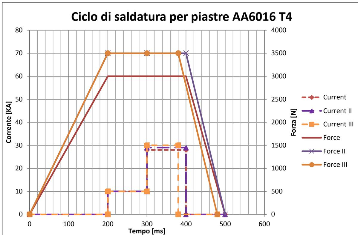
Figura 52: Grafico dell'andamento forza e corrente di saldatura per leghe di alluminio.
