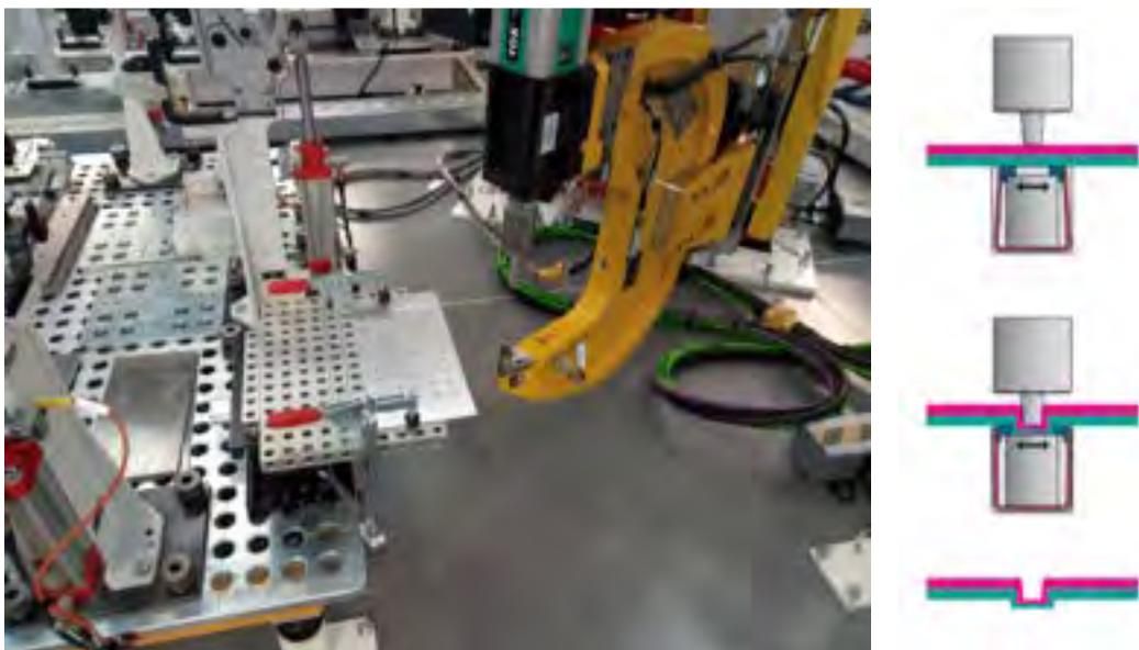
Figura 56: Pinza robotizzata di clinchiatura TOX PRESSOTECHNIK e principio di funzionamento.
