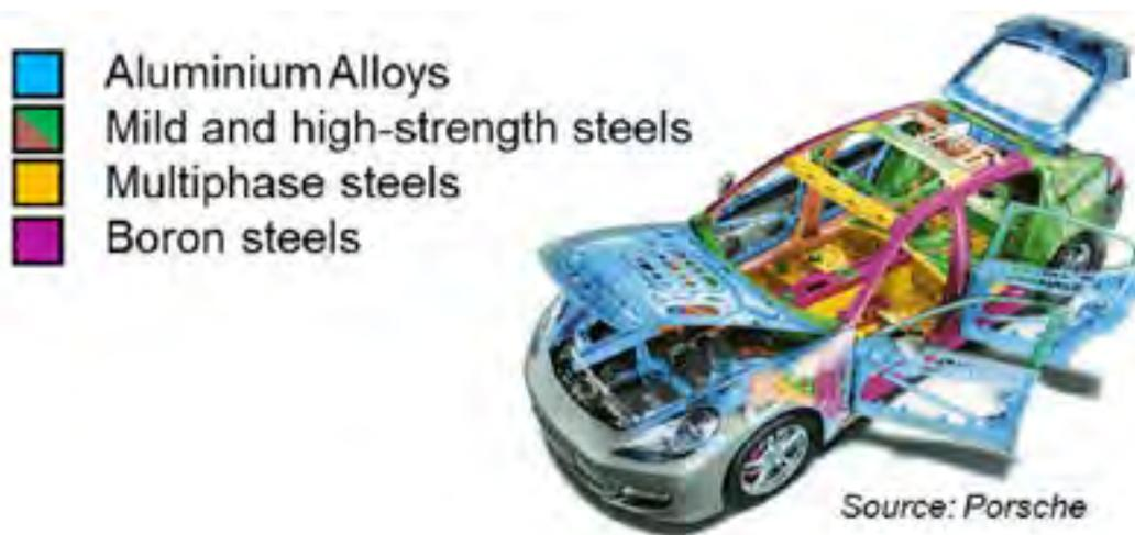
Figura 4– Porsche 970 Panamera con struttura in alluminio e acciaio al boro [5].
