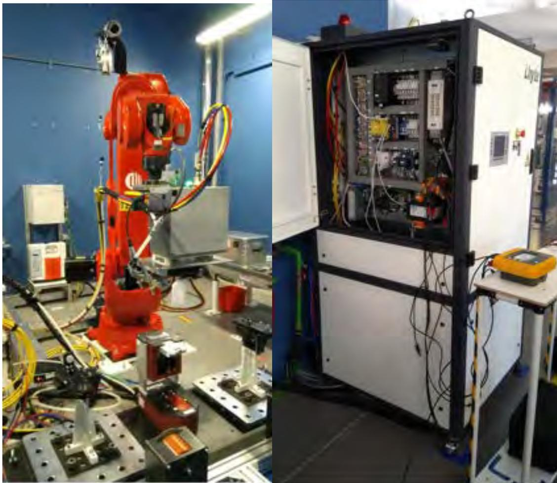
Figura 18: Sistema di saldatura laser con testa scanner remota e set di misura di efficienza energetica del sistema. A dx la sorgente laser compatta LyTe da 3500 W nominali; a sn il robot con testa scanner per saldatura remota, in basso il sistema PRIMES per la caratterizzazione del fascio.
