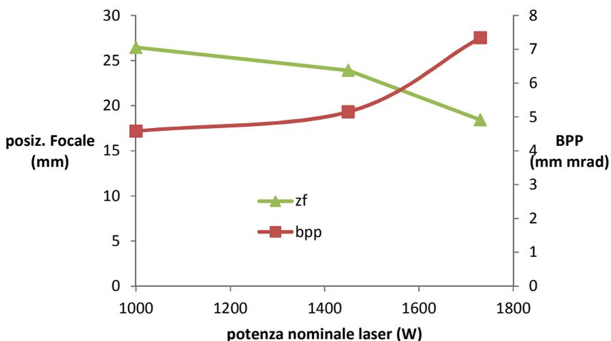
Figura 27: variazione di parametri qualitativi principali del fascio laser al variare della potenza.
