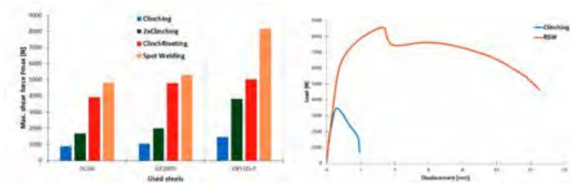
Figura 62: Comparazione fra la resistenza per clinchiatura e per RSW su acciai [1]
