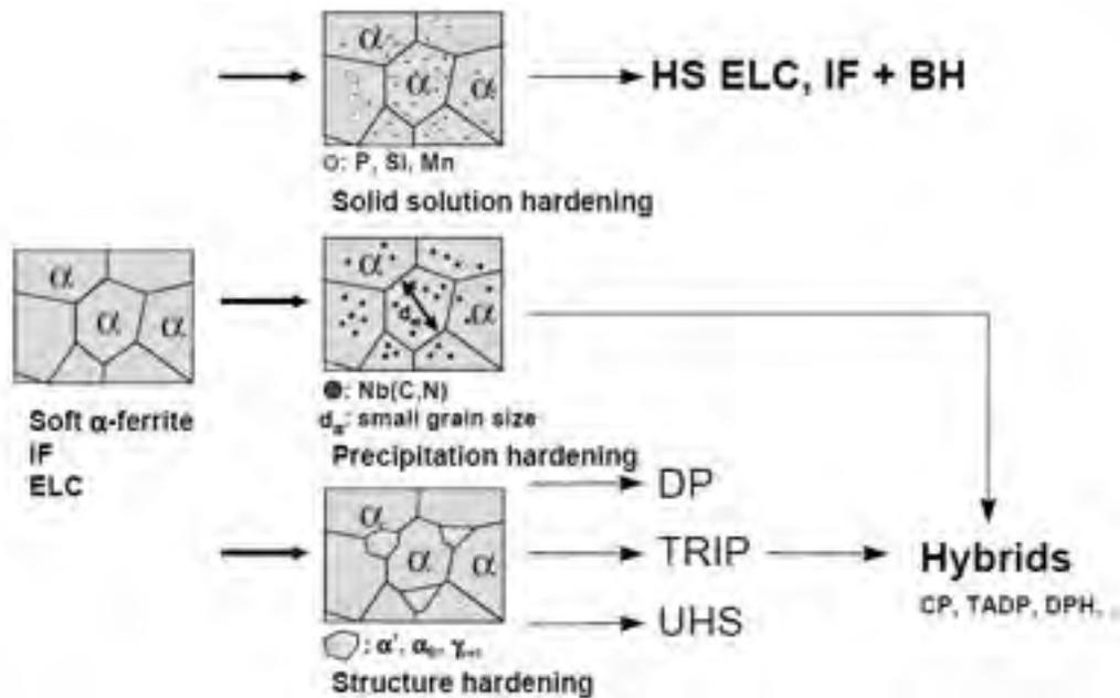
Figura 13: Meccanismi di miglioramento delle proprietà meccaniche in piastre di acciai basso legati per il settore automotive.
