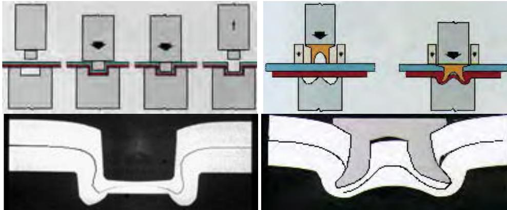
**Figura 6– Schematizzazione e sezione di una giunzione realizzata mediante clinching (sn) e self-piercing riveting (dx) [9].**
