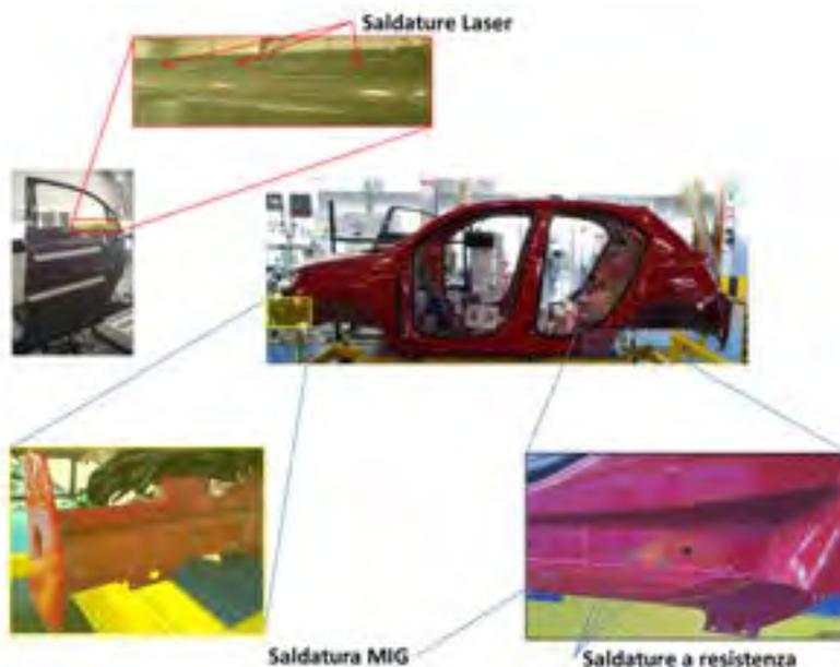
Figura 1– Principali tecniche di saldatura utilizzate nella produzione di un veicolo standard.
