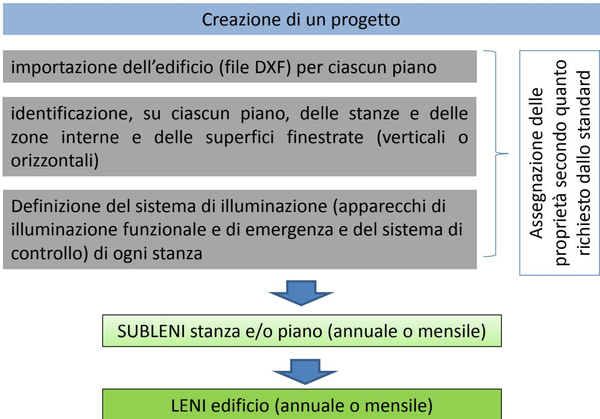
Figura 16. Schema funzionale degli step che costituiscono LENICALC
