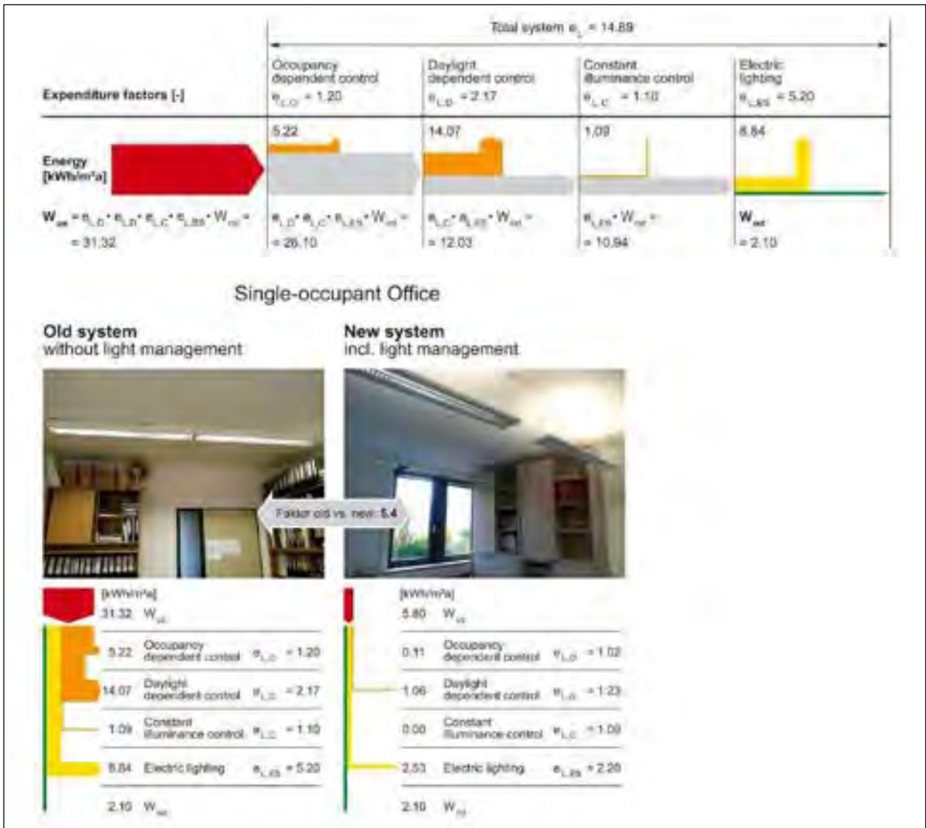
Figura 10. Confronto dei flussi energetici di un ufficio singolo nel caso di impianto di illuminazione esistente e nuovo
