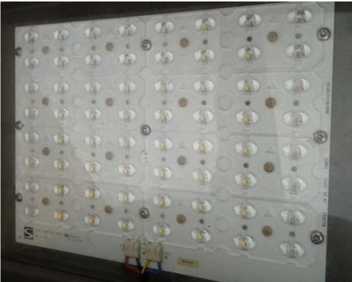
**Figura 7- Lampada a matrice di LED**
