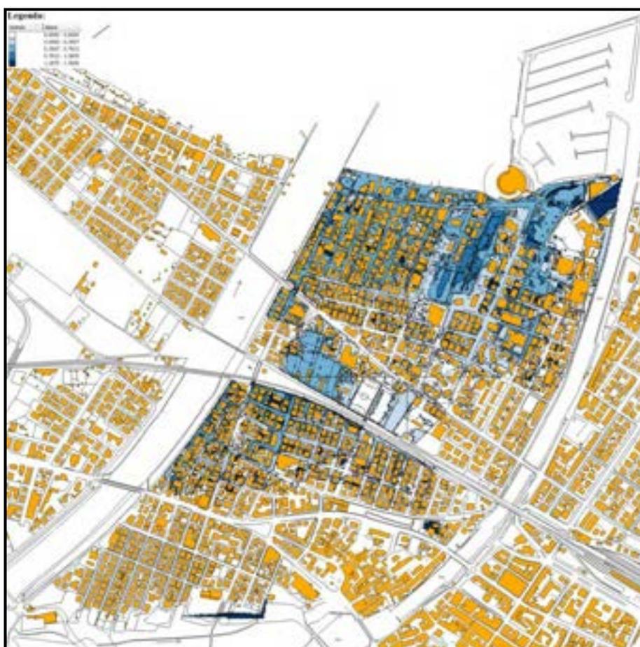
Figura 44: aree allagate su planimetria con edifici (simulazione 5)
