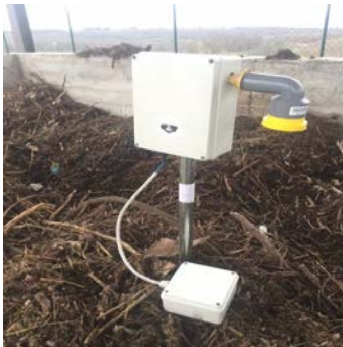
FIGURA 3. Sistema multi-sensore collocato su asta cava inserita nel cumulo
