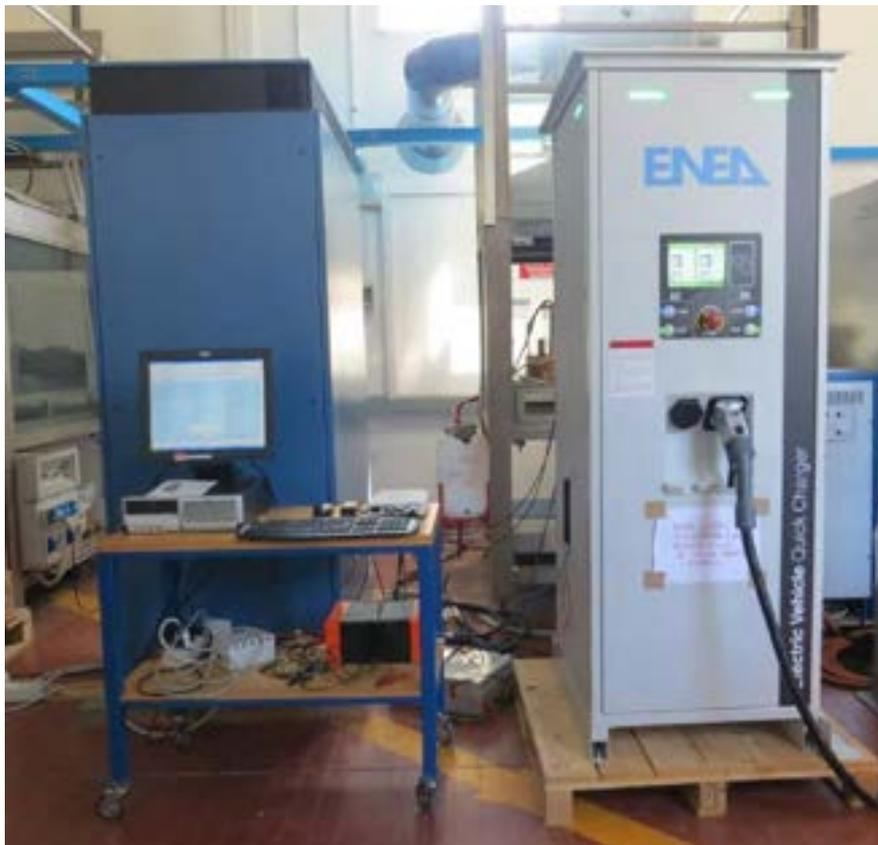
Figura 9 : stazione di ricarica da 50 kW c.c.
