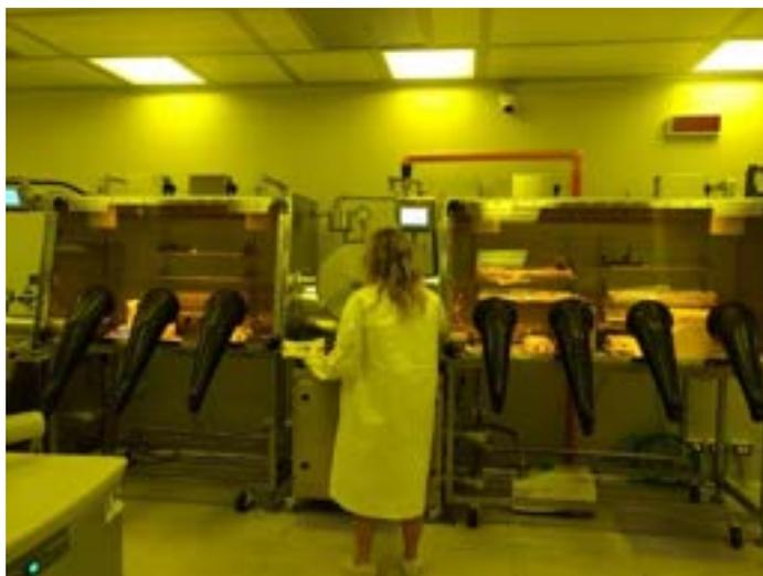
**Figura 15. Sistema composto da due glove box**
