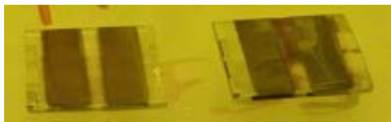
Figura 4. Fotografie di film di perovskite stampati e sottoposti a lavaggio singolo con pentano (sinistra) e doppio lavaggio IPA+pentano (destra). I film sono stati ottenuti mediante stampa (con 6 ugelli) di MAI su vetro/FTO/c-TiO 2 /m-TiO 2 /PbI 2 .
