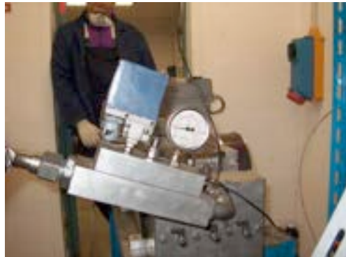
Figura 2 Misuratore di pressione e relativo limitatore di pressione
