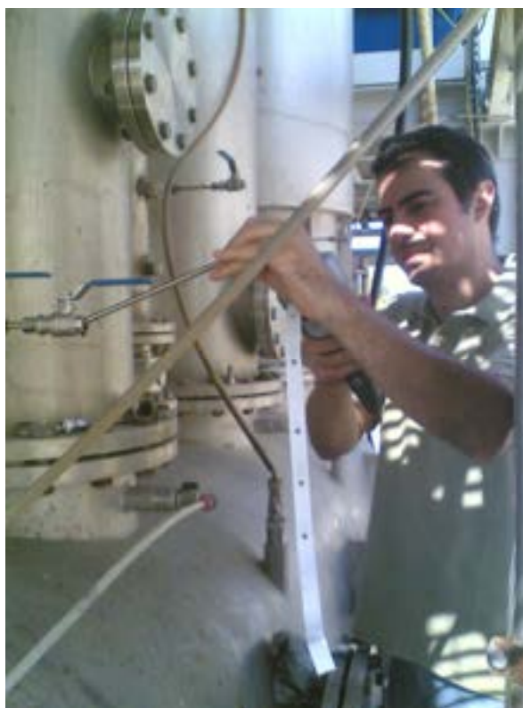
Figura 1 - Operazione di misura dell'indice di sporco tramite opacimetri e tabella di riferimento
