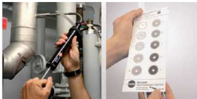
Figura 3 - Utilizzo dell'opacimetro manuale
