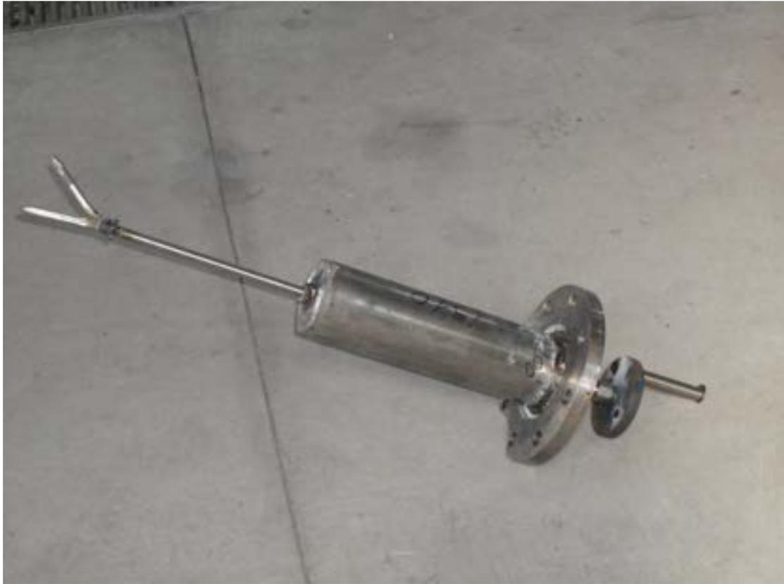
*Foto10. sistema di movimentazione del letto del gassificatore*
