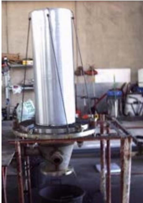
*Figura 3.8 Sistema sperimentale per simulazione scarico ceneri*
