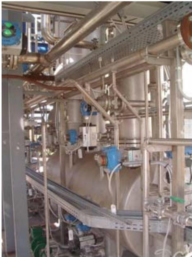
*Figura 2.2. Sistema di lavaggio del syngas.*
