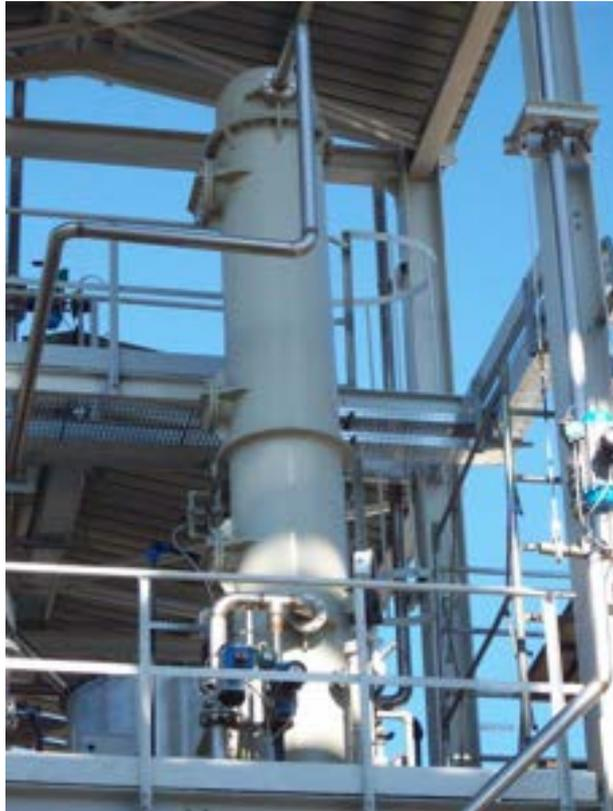
*Figura 2.3. Colonna di desolforazione a freddo del syngas.*
