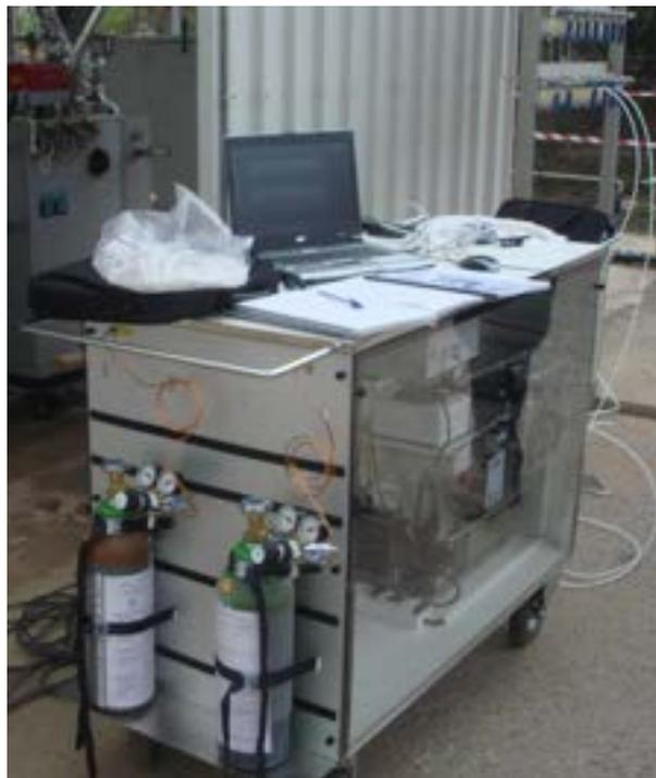
*Figura 2.4. Gas cromatografo portatile per la misura della composizione del syngas.*
