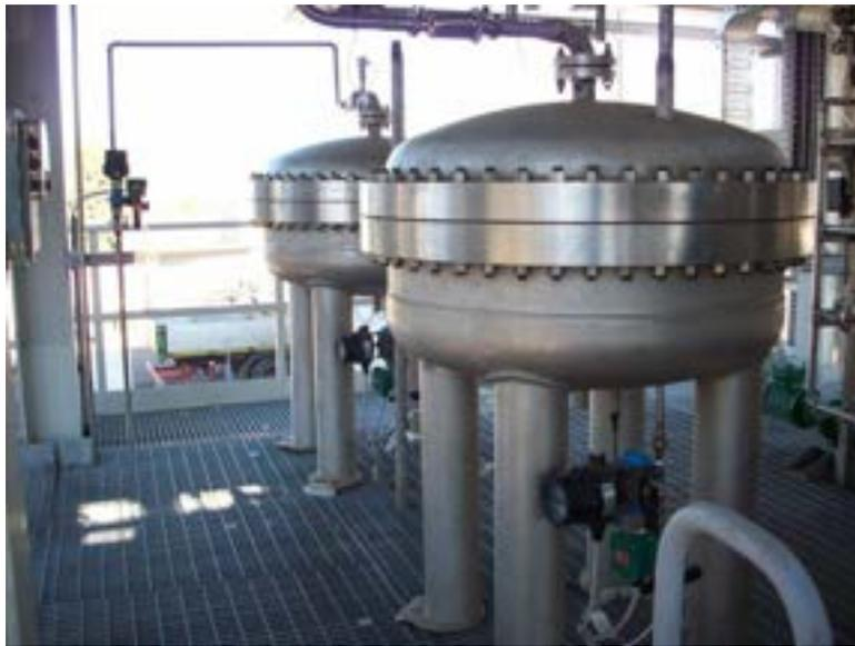
Figura 2.3. Reattori di assorbimento dell'anidride carbonica.
