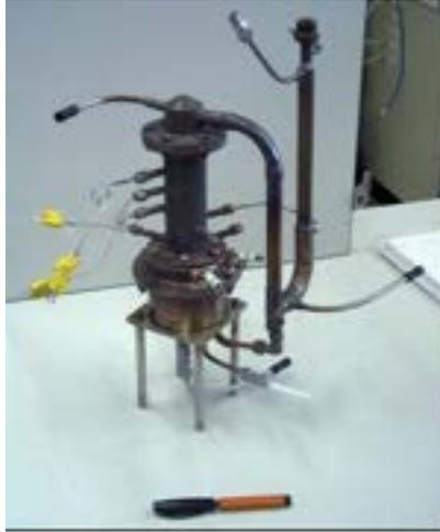
**Figura 13. Reattore autotermico**
