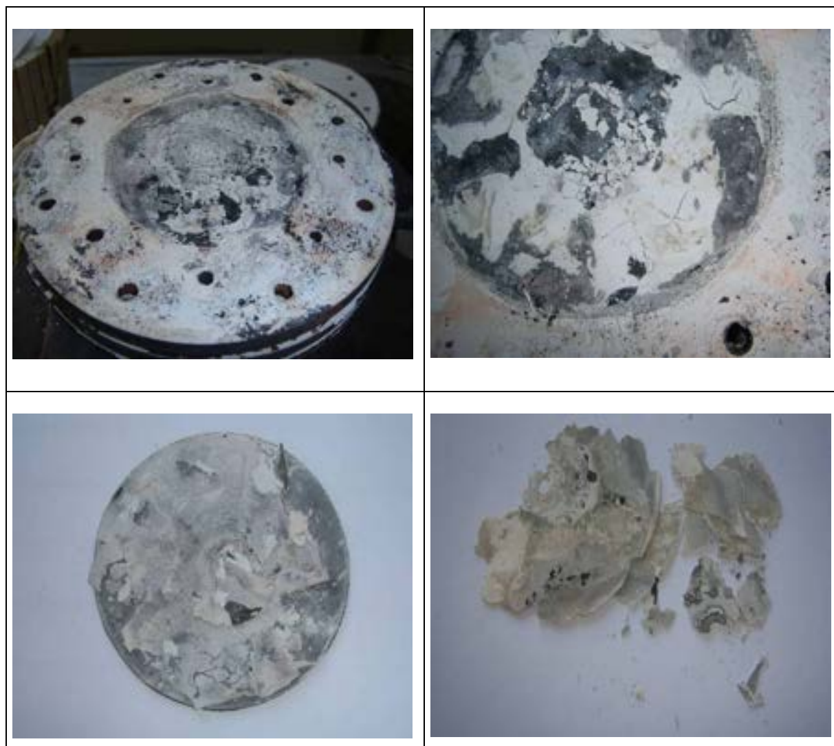
Figura 16 – Particolari riscontrate sulle matrici dopo lo smontaggio
