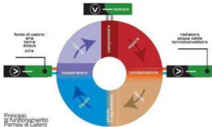
Fig. 1 - Principio di funzionamento di una pompa di calore
