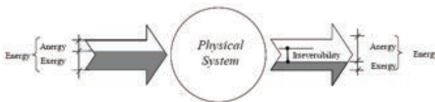
Figura 3. Flussi di Exergia ed energia attraverso un sistema fisico (Ref. Marletta, L., Exergy analysis of solar cooling, 2008)
