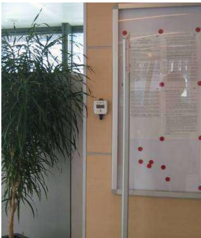
Figura 4: Tipica installazione di un logger di temperatura ed umidità relativa.
