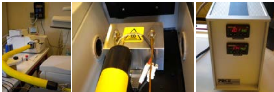
Figura 2: collegamento TGA-DSC e FT-IR, attacco della transfer line sulla cella riscaldata e controllore di Temperatura
