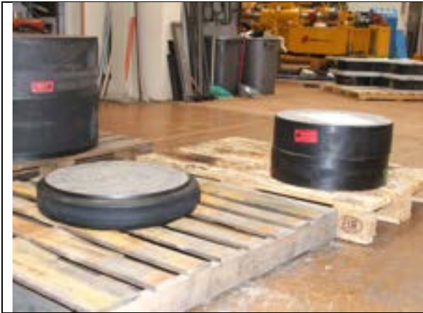
Isolatore prima e dopo la prova di carico verticale e sua sezione
