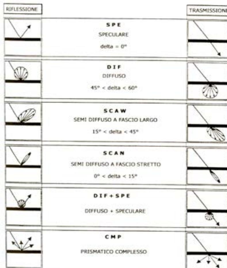
Figura 2.1. Modalità di trasmissione e riflessione della radiazione luminosa.
