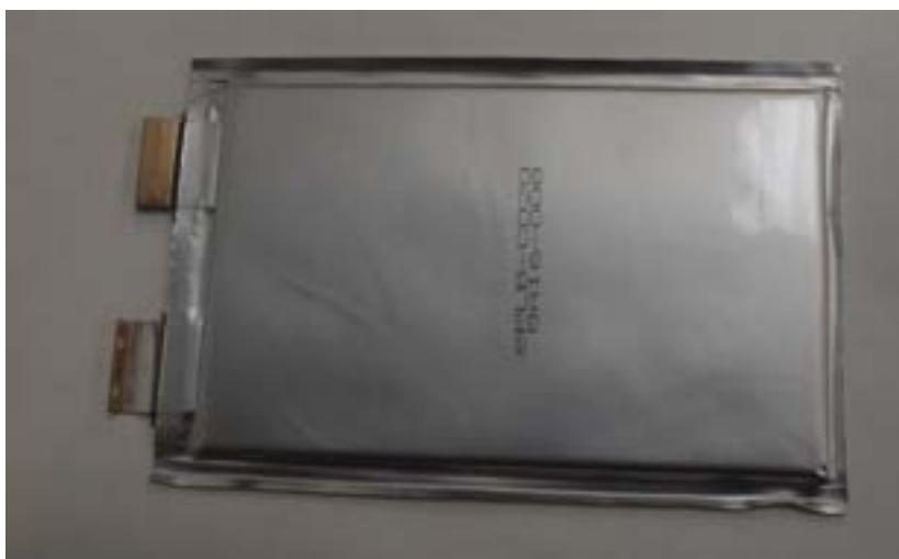
Figura 8. Cella al litio EIG da 20 Ah per prove di laboratorio.
