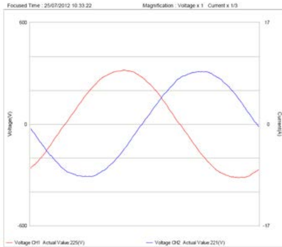
Figura 7. Forma d'onda della tensione linea Luce custode e linea F.M. custode.
